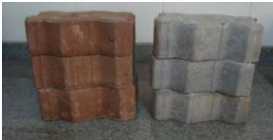
**Figura 4 - Blocos de pavimentação fabricados com rejeitos de minério de ferro.**
