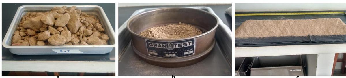
**Figura 11- Preparação de amostra para testes de picnometria, análises granulométrica, química e mineralógica. a) Rejeito em uma bandeja antes de ser levado para estufa. b) Rejeito sendo desaglomerado e passado por uma peneira de 0,42 mm de abertura. c) Homogeneização do rejeito por pilha alongada.**
