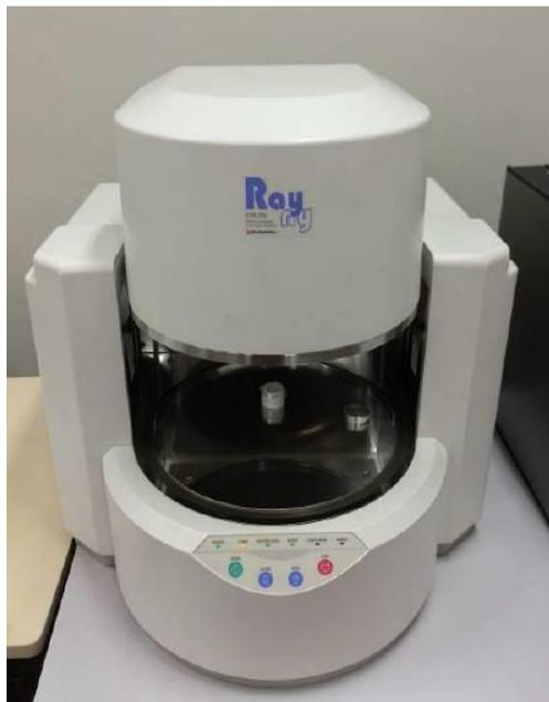
Figura 14 - Espectrômetro de Fluorescência de Raios-X por energia dispersiva.
