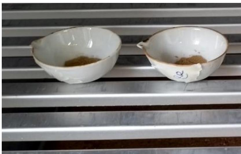
**Figura 16 - Cadinhos com amostras na estufa à temperatura de 105°C.**
