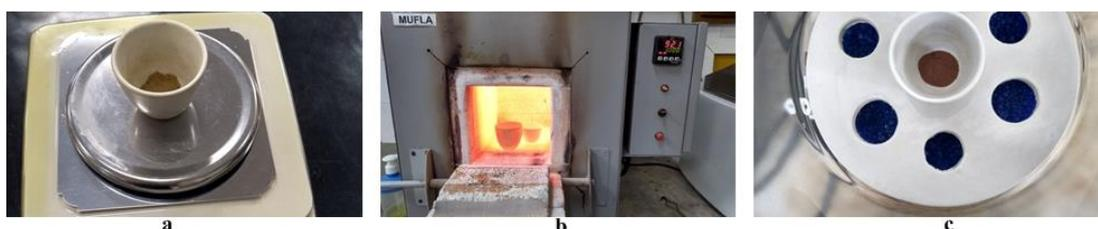
Figura 17- Teste de perda ao fogo. a) Cadinho de porcelana com amostra de rejeito de minério fosfatado. b) Cadinho com amostra na mufla à 1000°C. c) Cadinho com amostra no dessecador.
