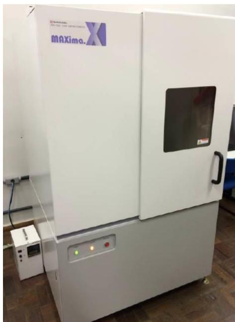
**Figura 15- Difratorômetro de Raios-X.**
