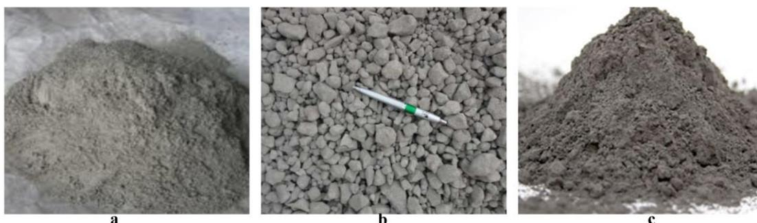
Figura 8 - Exemplos de pozolanas artificiais. a) Cinzas volantes. b) Escórias de alto-forno. c) Sílica ativa.
