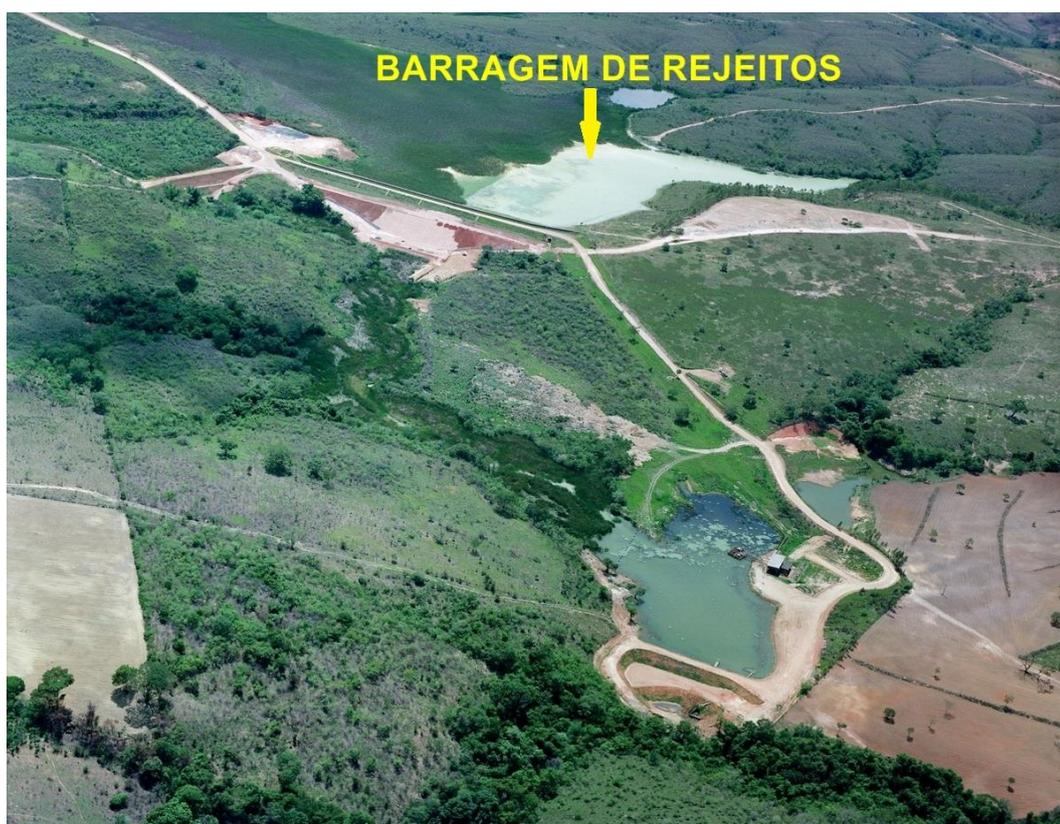
**Figura 10 - Barragem de rejeito de minério fosfatado de origem sedimentar.**
