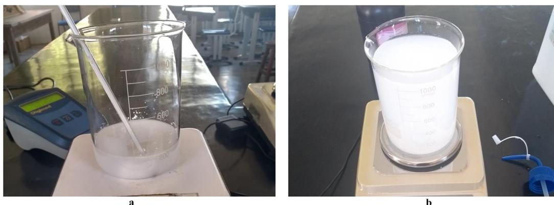
**Figura 19- Método de Luxàn. a) Solução supersaturada de hidróxido de cálcio P.A.. b) Adição até 1000 gramas de água de destilada a solução.**
