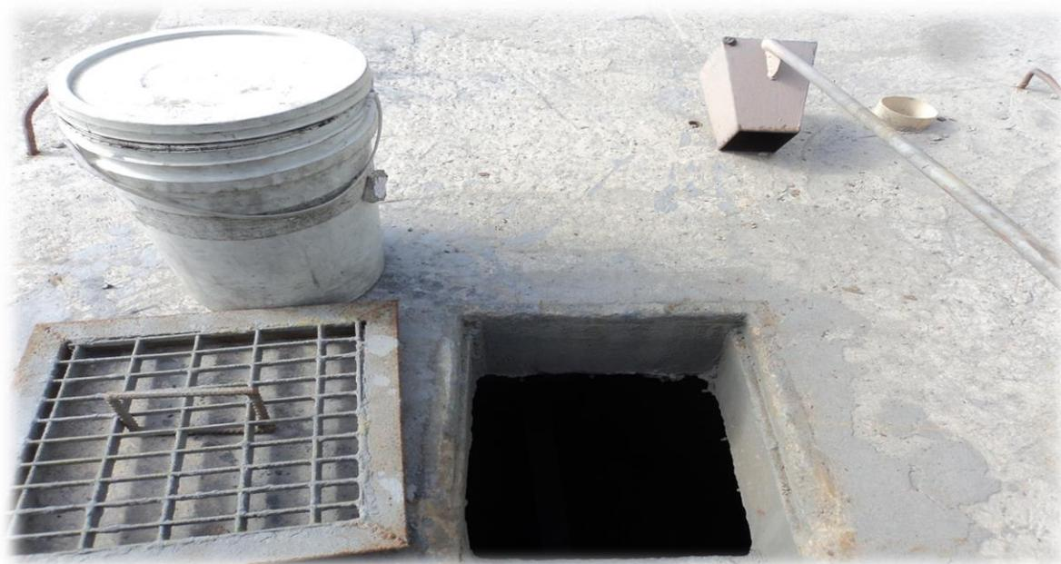
**Figura 4.1: Balde para armazenamento e dispositivo para coleta de fluxo**
