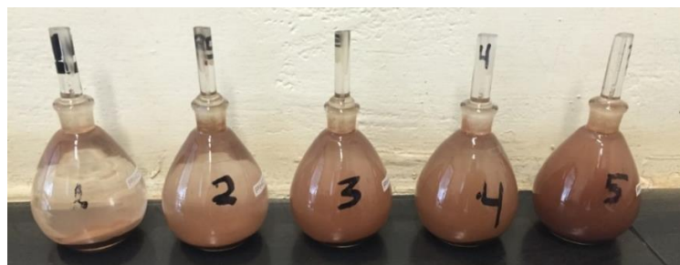
Figura 3.12 - Pícnômetros com a amostra e preenchidos com água.
