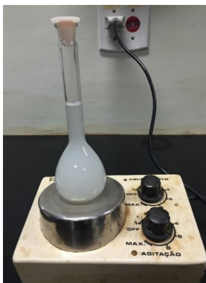
Figura 3.15 - Preparação do reagente depressor.
