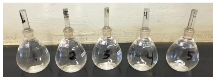
Figura 3.13 - Pícnômetros limpos preenchidos com água.
