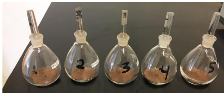
Figura 3.11 - Pícnômetros com amostra do minério.
