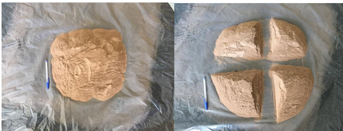
Figura 3.4 - Formação de pilha cônica e quarteamento.
