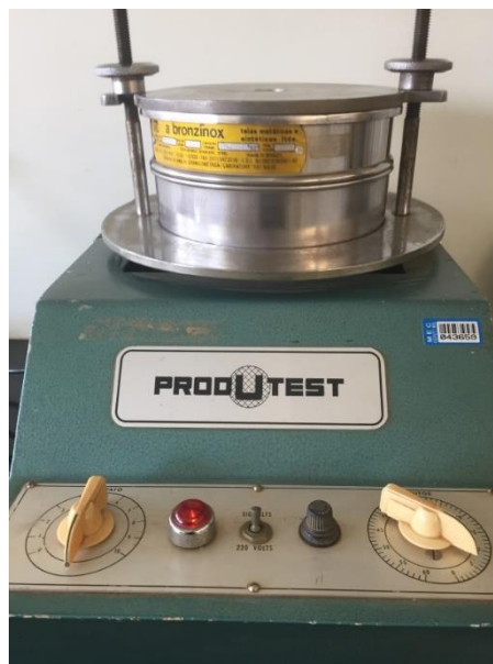
Figura 3.3 - Peneiramento utilizando peneirador vibratório de bancada.
