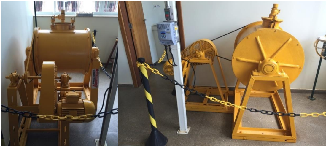
Figura 3.2 - Moinho de bolas utilizado na moagem do minério de ferro.
