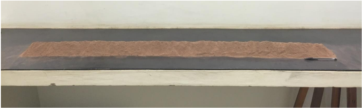
Figura 3.8 - Pilha alongada para quarteamento em alíquotas.
