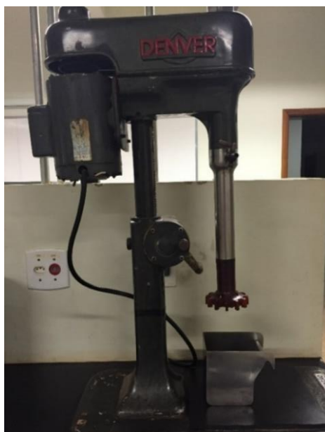
Figura 3.17 - Célula de flotação tipo Denver utilizada nos testes.
