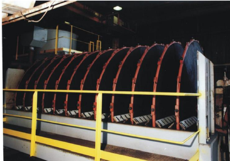
Figura 3.6- Visão externa do filtro de discos. Fonte: Amarante, 2002.
