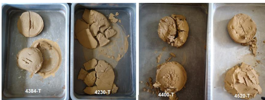
Figura 5.17- Tortas geradas com os quatro tecidos. Fonte: Autoria própria.
