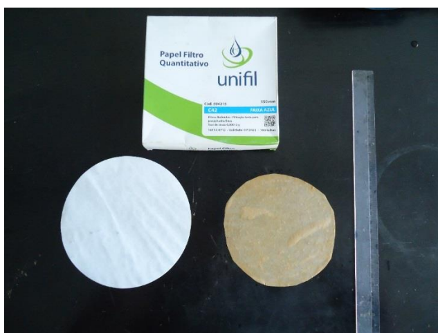
Figura 4.24- Papel filtro antes e depois do uso. Fonte: Autoria própria.
