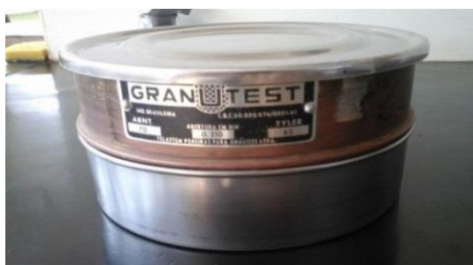
Figura 4.7- Peneiras circulares Granutest. Fonte: Autoria própria.
