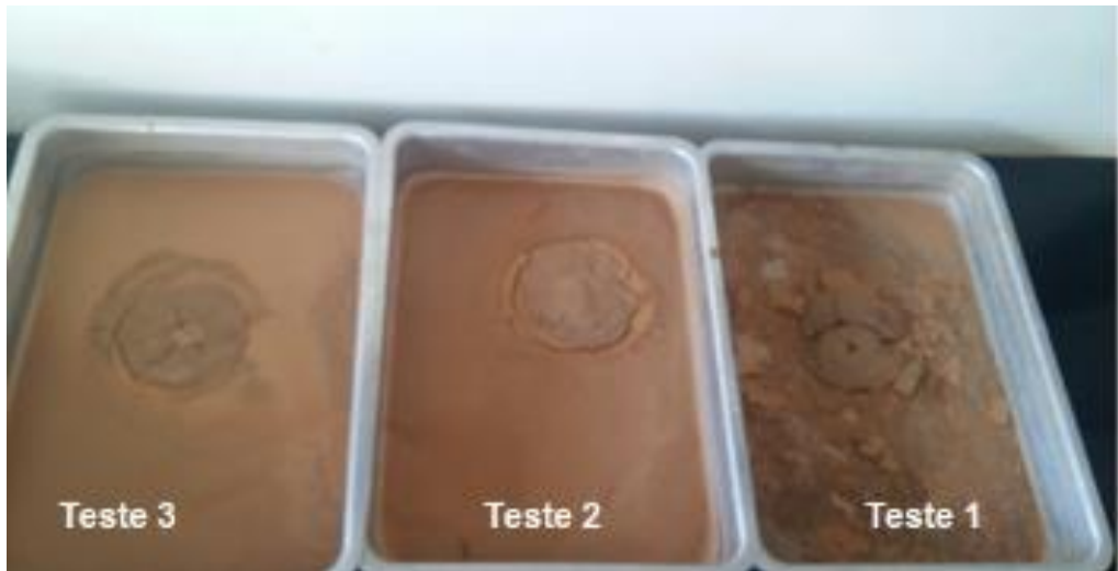
Figura 5.8- Tortas secas para o tecido 4384-T. Fonte: Autoria própria.
