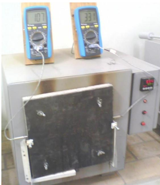
Figura 5.1 - Dispositivo de avaliação da capacidade de isolamento térmico. Oliveira *et al.* (2015).
