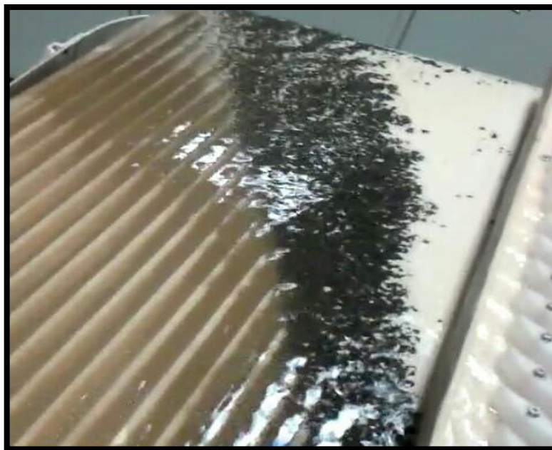
Figura 3.1: Etapa de concentração gravítica do material empregado nos testes de lixiviação, utilizando a mesa concentradora do LTM.
