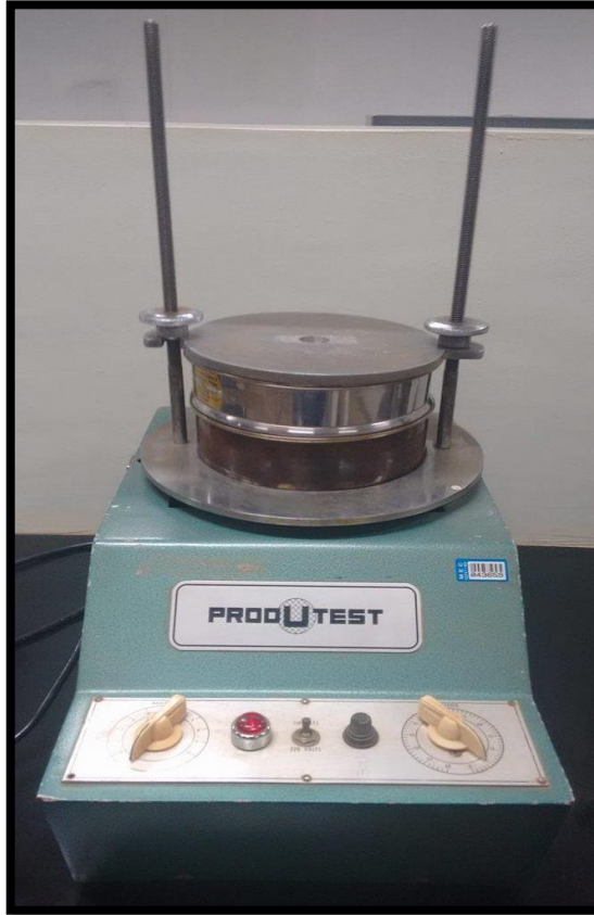
Figura 3.5 - Peneiramento do rejeito magnético após a moagem no almofariz.
