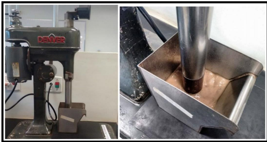
Figura 3.2 - Atrição na superfície das partículas do material.
