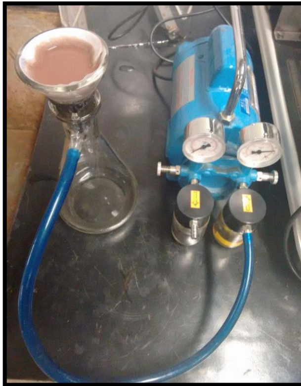
Figura 3.7 - Filtragem das amostras de licor de lixiviação.
