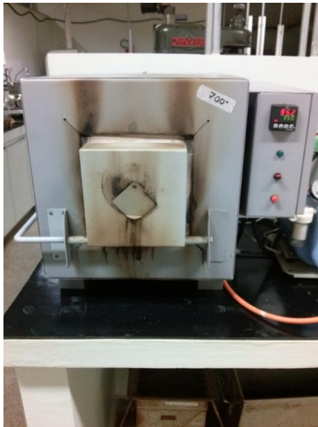
Figura 3.3: Mufla utilizada no ensaio de perda ao fogo
