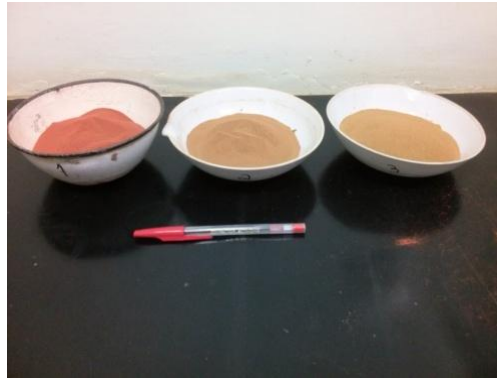
Figura 3.7: Amostras peneiradas na peneira de abertura 0,42 mm para ensaio de LL e LP
