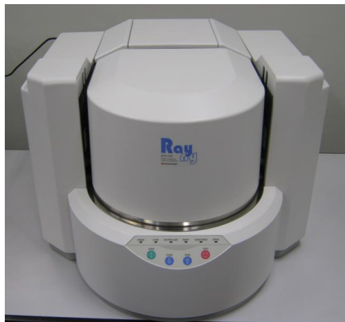
Figura 3.13: Espectrômetro utilizado para realização da fluorescência de raios-x
