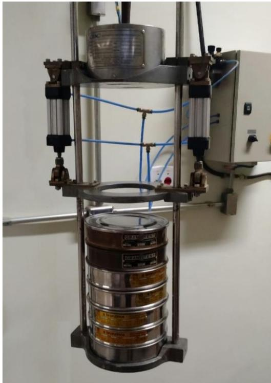
**Figura 3.13** - Peneirador suspenso utilizado nas análises granulométricas.
