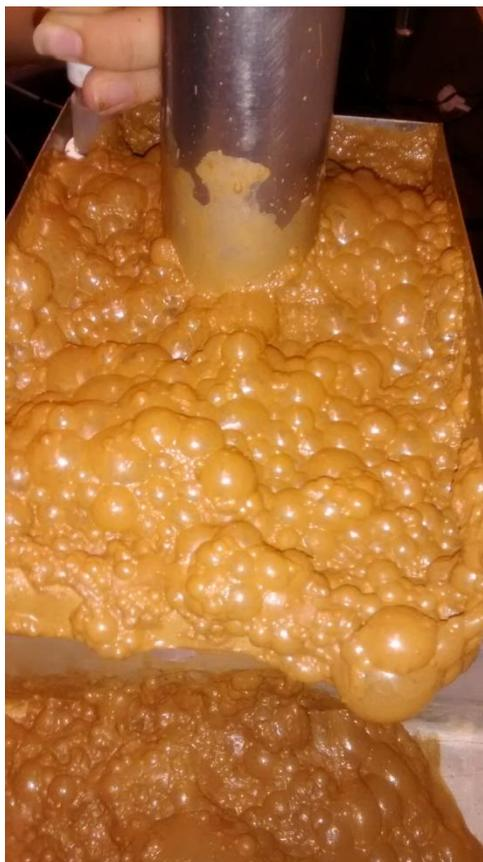
**Figura 4.5** - Espuma dos testes de flotação.
