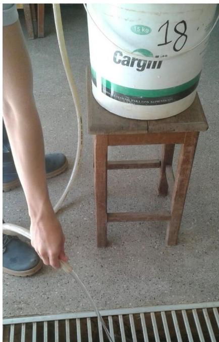
**Figura 3.10** - Deslamagem realizada no laboratório de Tratamento de Minérios.
