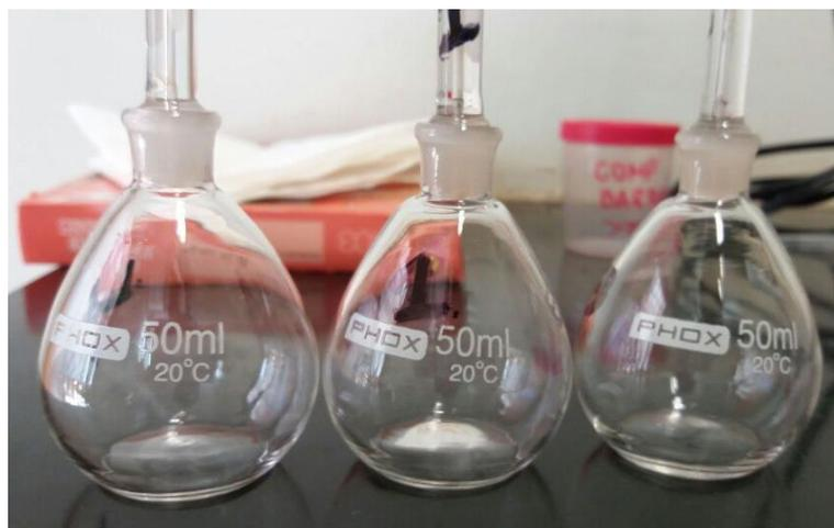
**Figura 2.2** - Pícnômetros utilizados para determinação de densidade de sólidos.
