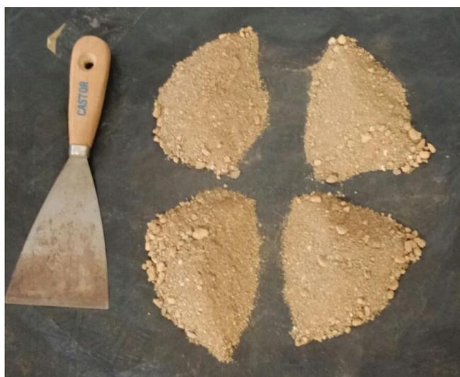
**Figura 3.6** - Quarteamento da pilha cônica para retirar amostra para análise granulométrica.
