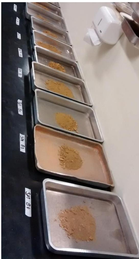
**Figura 3.21** - Amostras separadas para 8 testes de separação magnética de alto campo.
