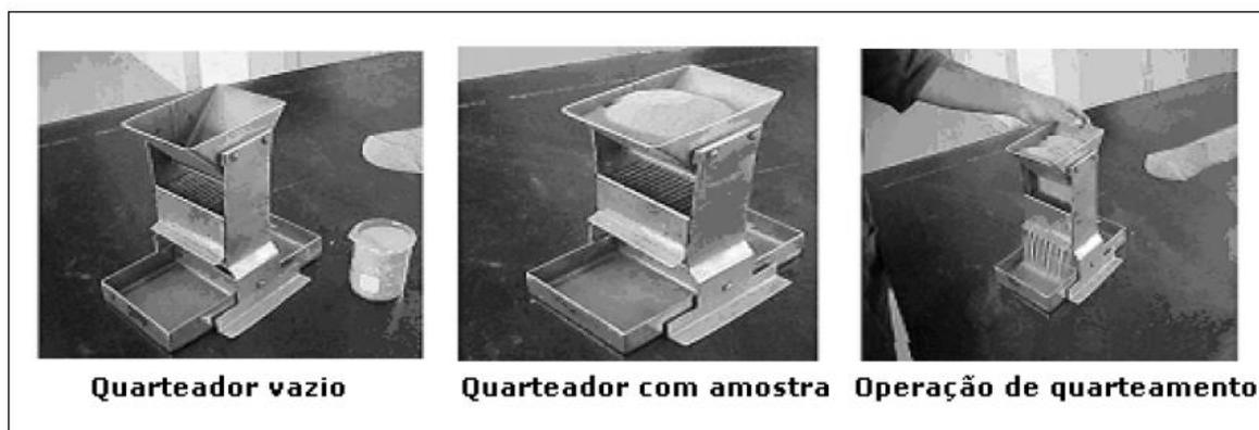
**Figura 3.7** - Representação esquemática do quarteador mecânico Jones.
