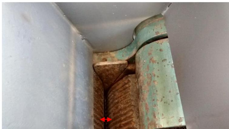
**Figura 3.4** - Vista superior do britador de mandíbulas com o set de abertura regulado em  $\frac{1}{2}$ ".
