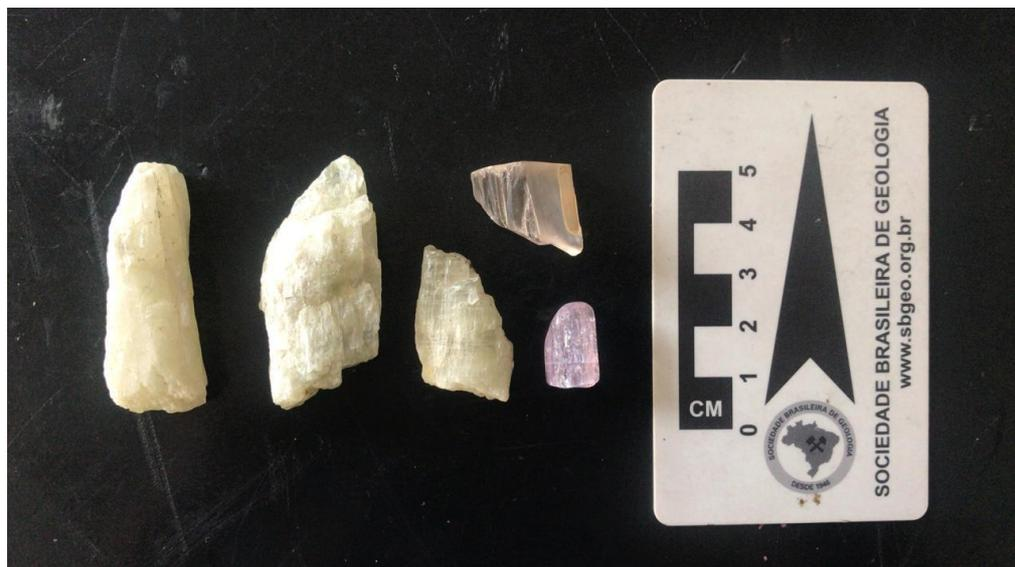
Figura 4 - Espodumênio. Foto tomadas no Laboratório de Mineralogia e Petrografia do CEFET-MG. Unidade Araxá.
