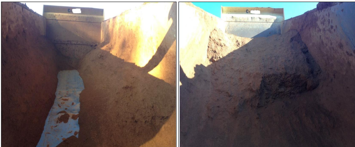
Figura 9 – Caminhões com material aderido a caçamba devido umidade do material.
