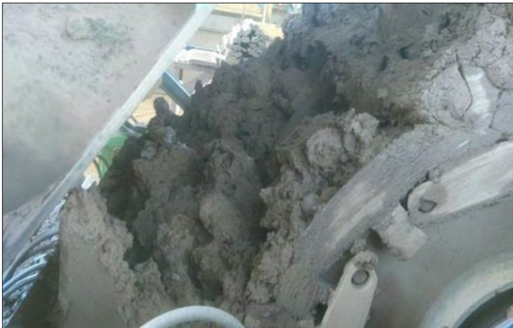
Figura 13 – Paralisação para desagregação de material no britador de impacto devido alta umidade do minério.
