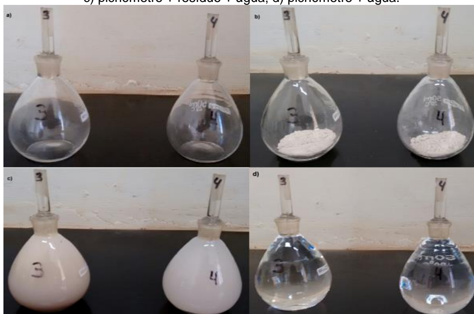
Figura 4.5 – Teste de picnometria. a) picnômetro vazio; b) picnômetro + resíduo; c) picnômetro + resíduo + água; d) picnômetro + água.
