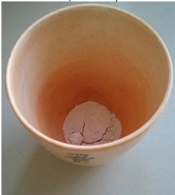
Figura 4.6 - Amostra no cadinho após a calcinação – Ensaio de Perda ao Fogo.
