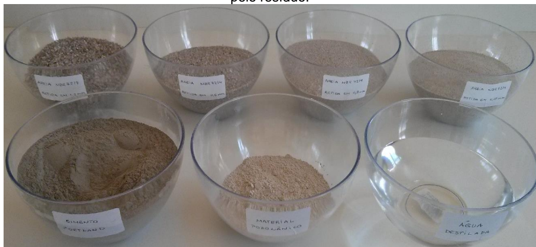
Figura 4.7 – Materiais para a confecção dos corpos de prova com substituição de 35% de cimento pelo resíduo.
