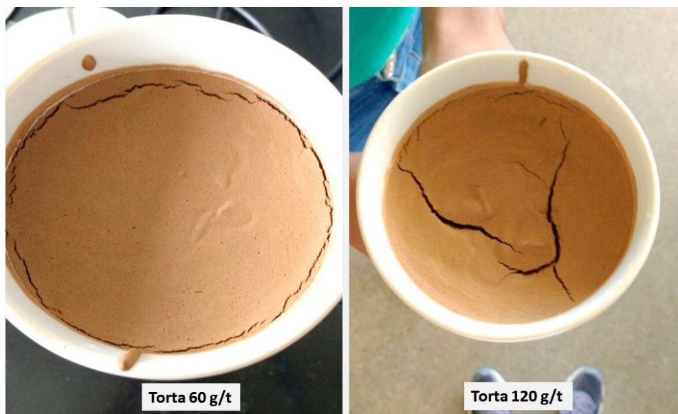
Figura 4.6 - Comparações das trincas nas tortas com 60 e 120 g/t de Surfactante Comparações das trincas nas tortas com 60 e 120 g/t de Surfactante.
