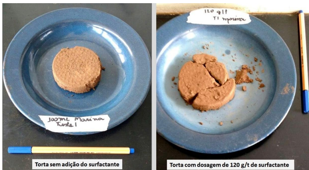
Figura 4.5– Comparação de uma torta com e sem reagente
