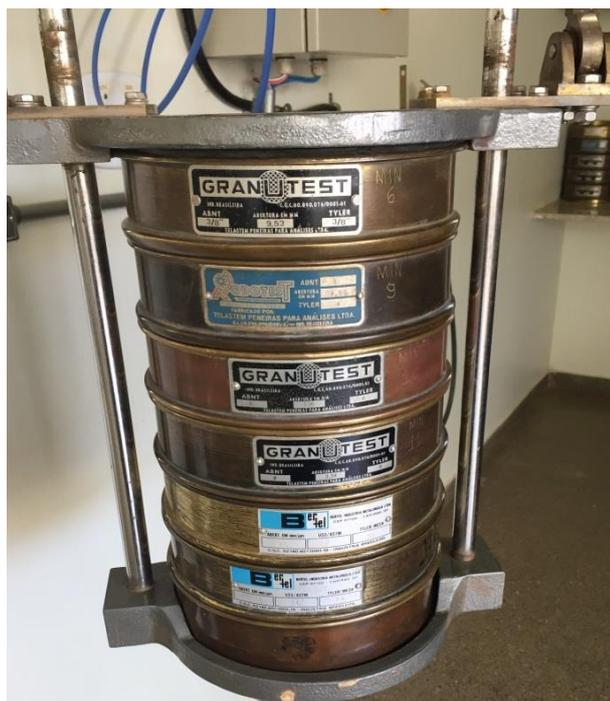
Figura 3.10 - Peneiramento a seco nas faixas entre 9,50mm e 1,18mm.
