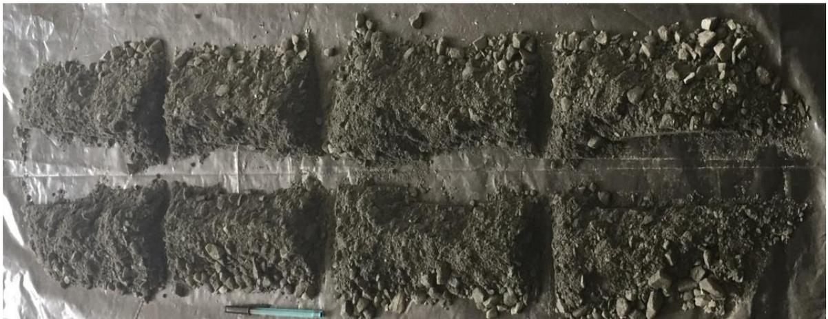
Figura 3.4 - Pilha Alongada segmentada.
