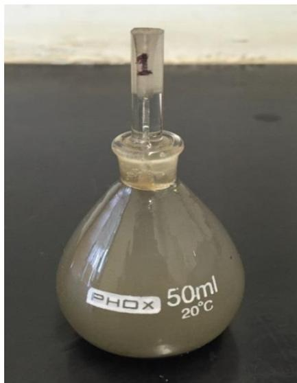
Figura 3.8 - Pícnômetro com amostra e água.
