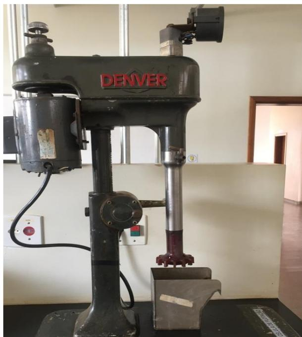
Figura 3.12- Célula de flotação.
