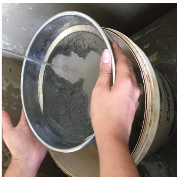
Figura 3.11 - Peneiramento a úmido na malha de 0,038 mm.
