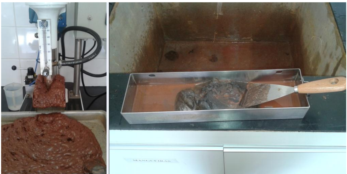
Figura 4.3 – Material flotado e material afundado respectivamente
