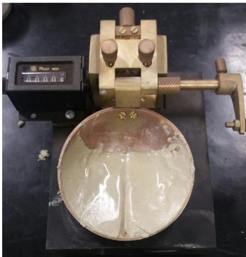
Figura 17: Ensaio Limite de Liquidez no aparelho Casagrande, após os golpes.
