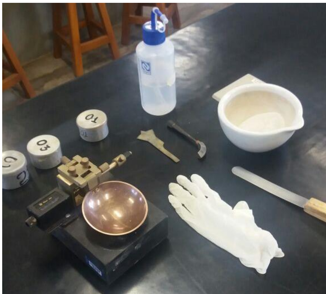
Figura 15: Amostra na capsula de porcelana e água destilada para realização do ensaio de Liquidez.
