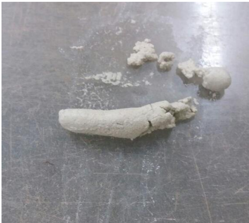
Figura 26: Cilindro para o ensaio de limite de plasticidade.
