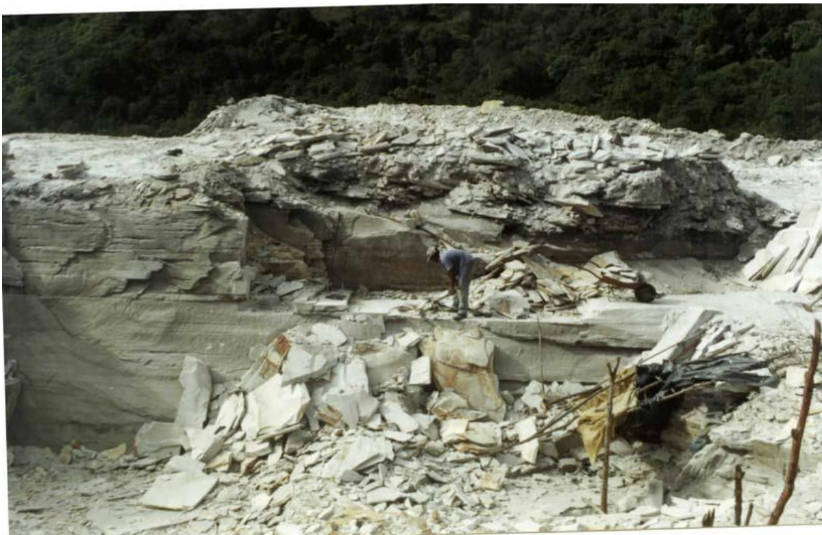
Figura 4: Exemplo de exploração do quartzito na região de Ouro Preto, por bancos e blocos irregulares Pires (2007).
