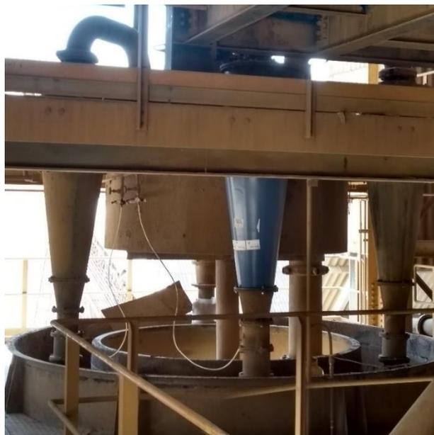
**Figura 7** - Bateria de hidrociclones da etapa de adensamento.
