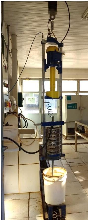
**Figura 9** - Peneirador suspenso.
