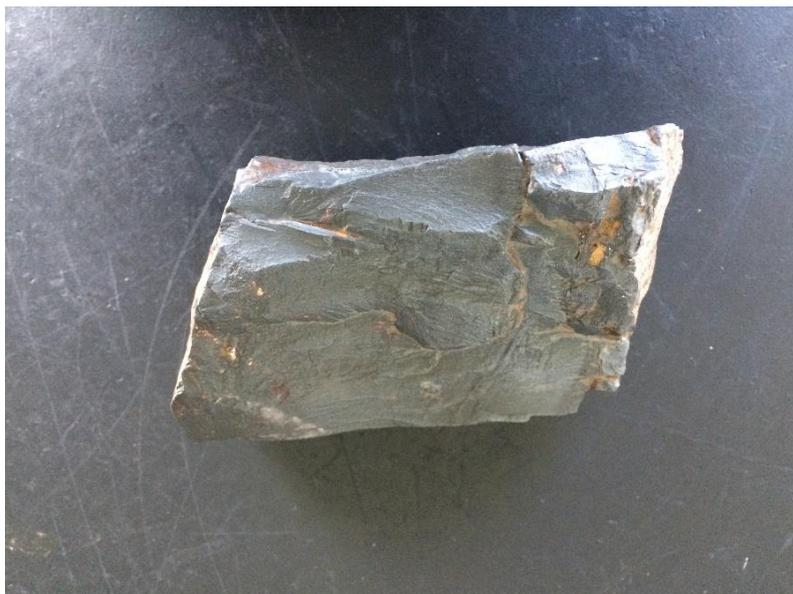
**Figura 2.1** - Hematita (Laboratório de Mineralogia - CEFET-MG Campus Araxá).
