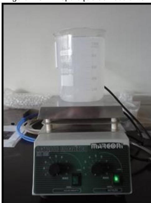
Para o ajuste de pH foi empregada uma solução de hidróxido de sódio (10% p/p), sendo que o controle deste parâmetro operacional foi realizado através de um
