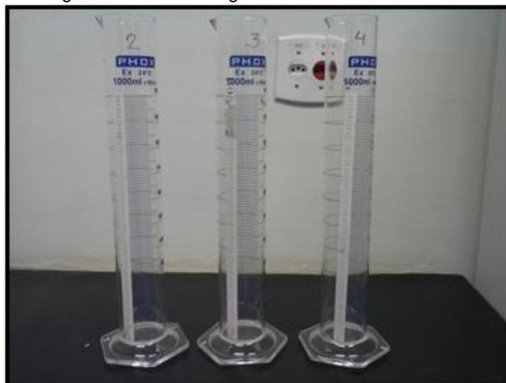
Durante o teste de sedimentação, a amostra de rejeito foi pesada em uma balança semi-analítica, assim como a massa de água e a massa de floculante para cada teste. Em seguida, a amostra de rejeito foi adicionada a uma proveta,
