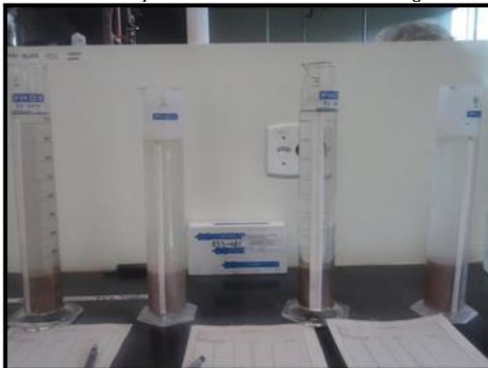
As curvas de sedimentação foram plotadas a partir dos valores obtidos com a altura da interface das polpas (Gráfico 5.4).
