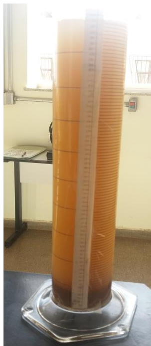
Figura 21 - Teste de proveta realizado para aplicação da metodologia de Oltmann.
