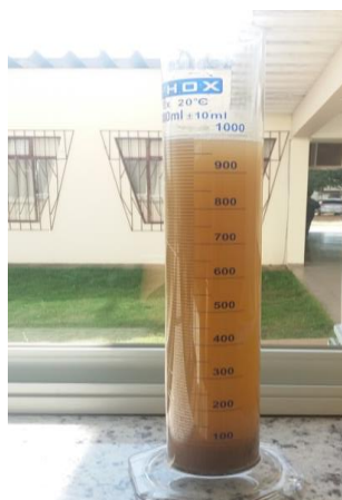
Figura 20 - Teste de proveta realizado para aplicação da metodologia de Talmage e Fitch.
