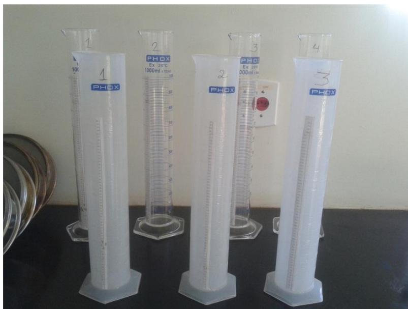
**Figura 4.8** - Provetas utilizadas nos testes de sedimentação
