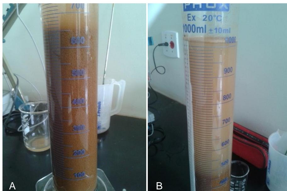
**Figura 5.6** - A) Formação de flocos em testes de pH igual a 12; B) Clarificação da água em testes de sedimentação de minério fosfático em pH igual a 12.
