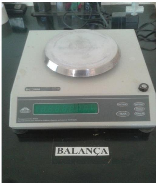
**Figura 4.3** - Balança semi- analítica usada nos testes
