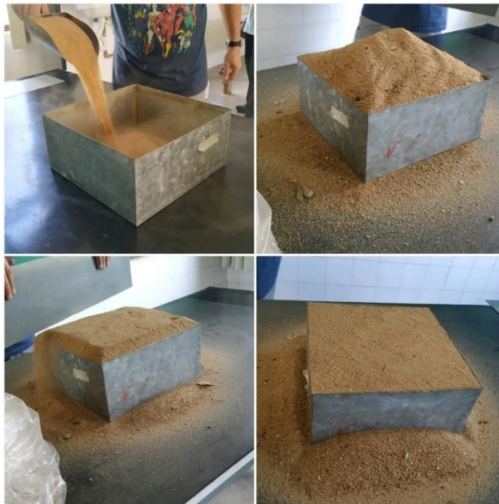
Figura 17 - Sequência de determinação da massa unitária da areia
