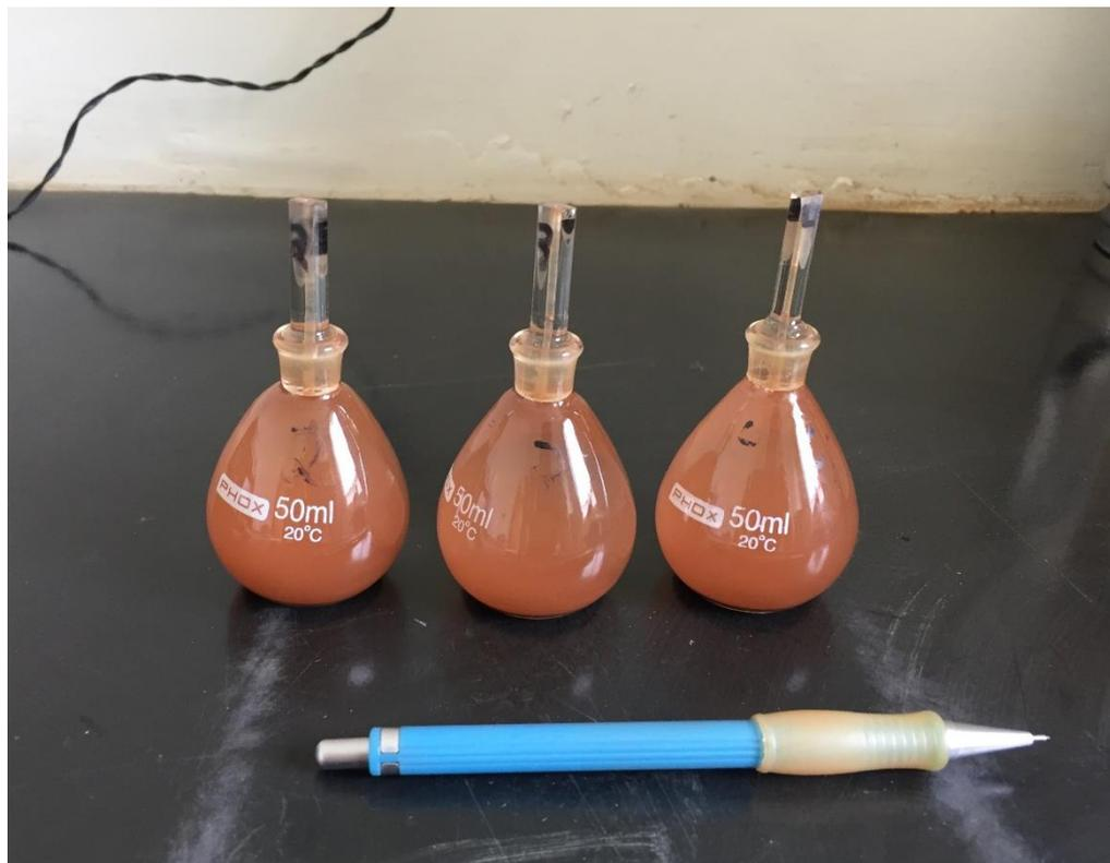
Figura 3.5– Pícnômetro com amostra e água.
