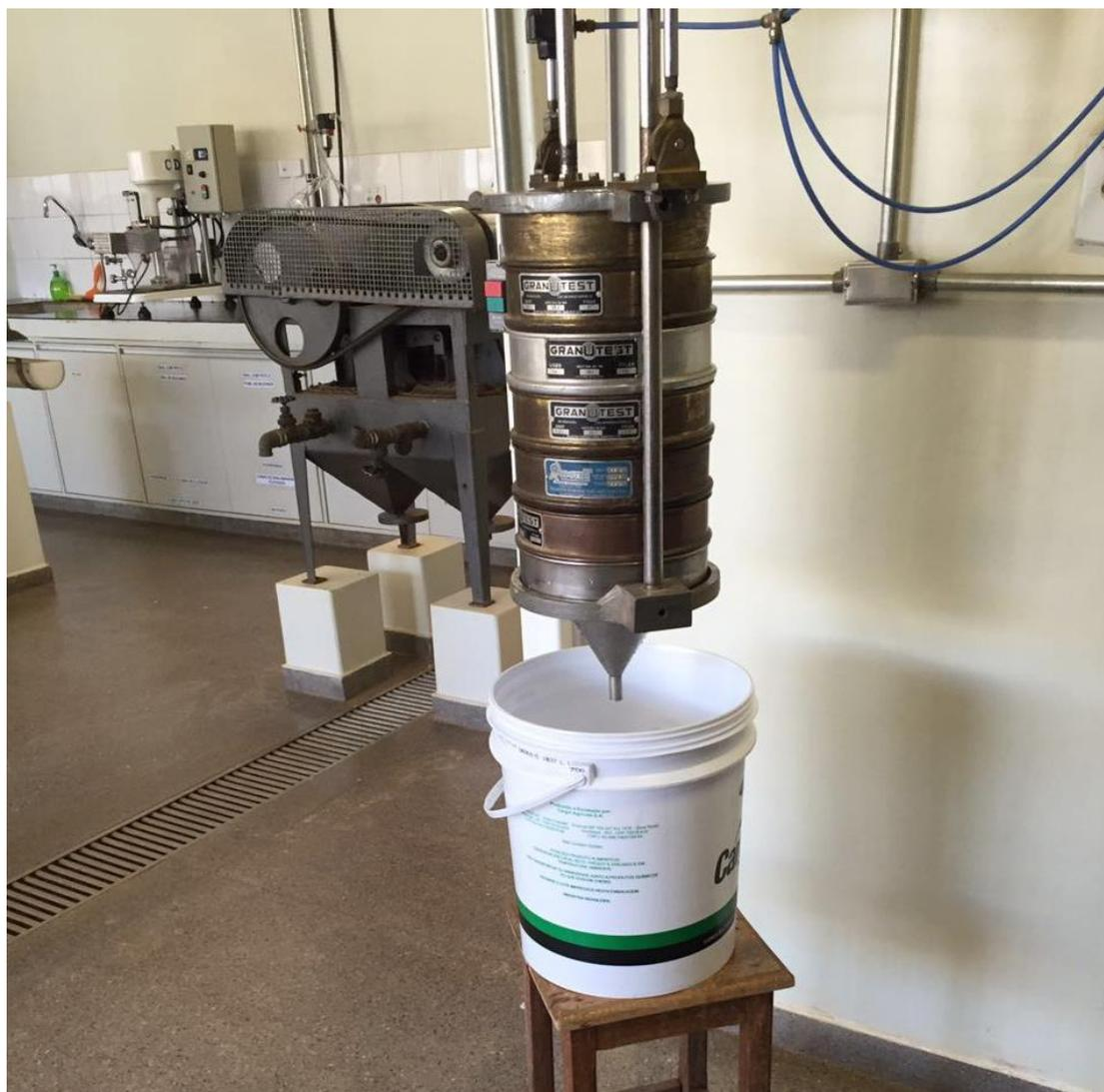
Figura 3.6 – Peneirador vibratório suspenso, adaptado para o peneiramento a úmido.
