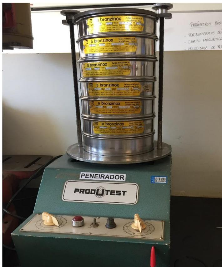
Figura 3.7 – Peneirador vibratório de bancada.
