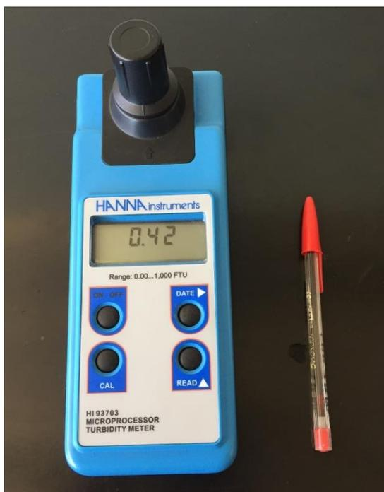
Figura 3.8 – Turbidímetro aferindo a turbidez da água.
