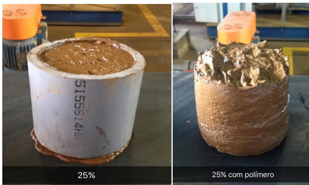
Figura 21 - Amostra com polímero a 25% de umidade.
