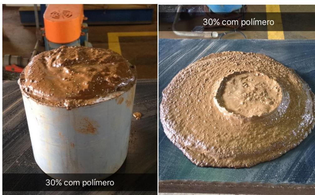
Figura 23 - Amostra com polímero a 30% de umidade.
