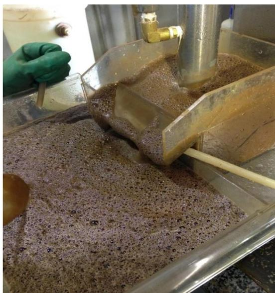
Figura 18-Flotação da amostra do teste do polímero.
