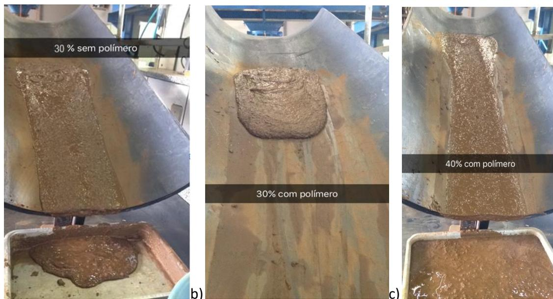
Figura 25- a) Material sem polímero com 30% de umidade; b) material com 30% de umidade e com polímero, c) material com 40% de umidade e com polímero.
