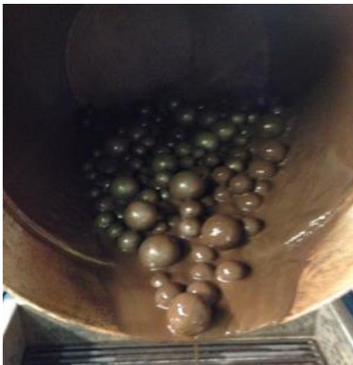
Figura 16-Fração retida do peneiramento moída.
