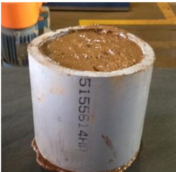
Figura 13- Ilustração do teste de abatimento.
