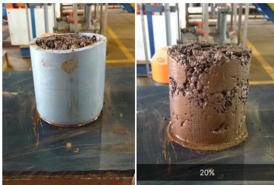
Figura 19-Amostra sem polímero a 20% de umidade.
