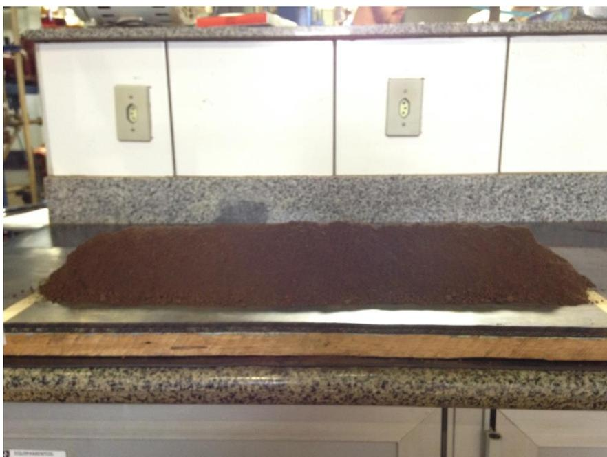
Figura 10-Pilha alongada formada sobre a bancada do laboratório.
