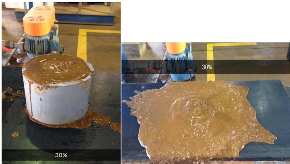
Figura 22 - Amostra sem polímero a 30% de umidade.
