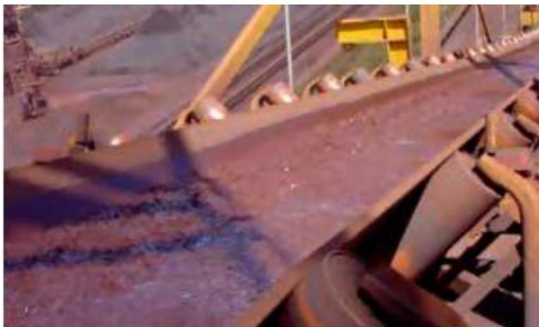
Figura 1- Material de alta umidade sendo transportado.
