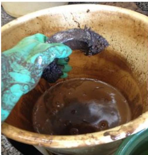
Figura 17-Magnetita sendo retirada da amostra.
