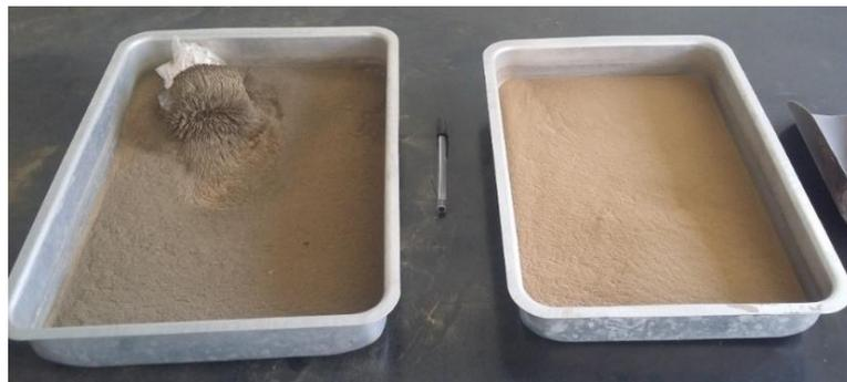
**Figura 3.5** - Material magnético e não magnético, respectivamente.
