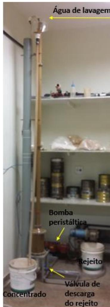
**Figura 3.14** - Coluna de flotação onde os testes foram realizados.
