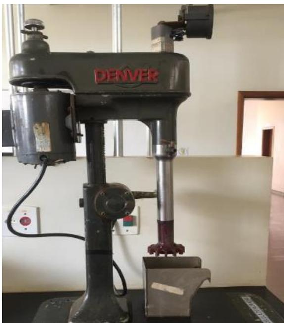
**Figura 3.11** - Célula mecânica Denver.
