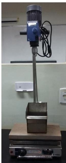
**Figura 3.13** - Agitador e chapa utilizados no condicionamento da polpa.
