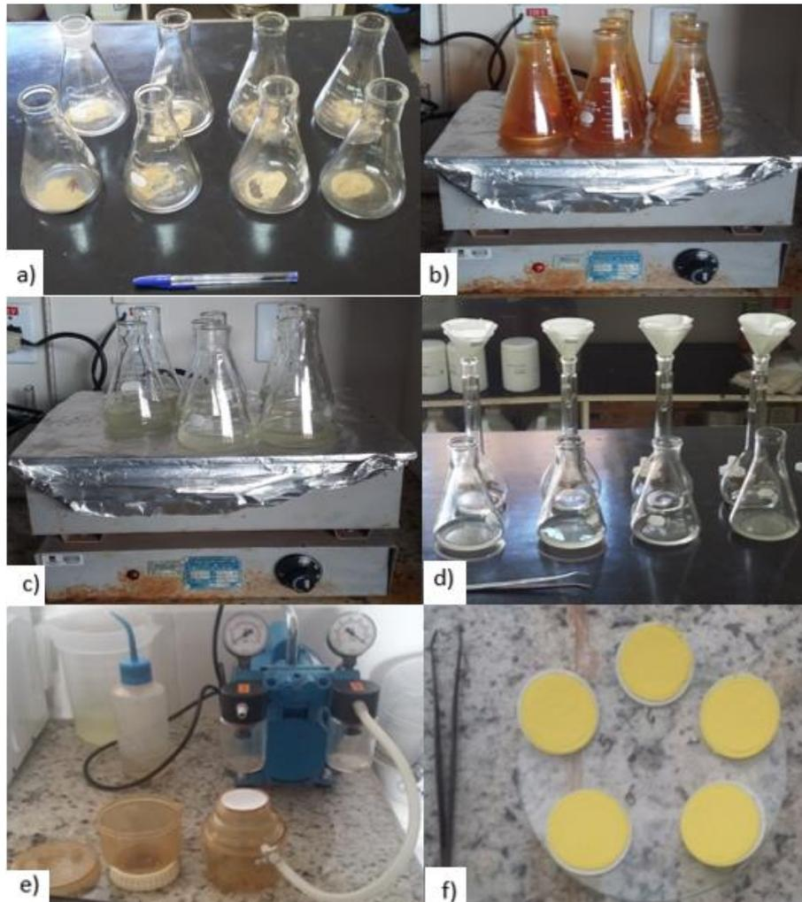
**Figura 3.8** - a) 1 grama de cada amostra, em um erlenmeyer de 250 ml; b) Desprendimento de vapores castanhos ( $NO_2$ ); c) Solução após a remoção dos vapores castanhos; d) Transferência de toda a solução
