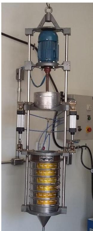
**Figura 3.9** - Série de peneiras e o peneirador vibratório suspenso.
