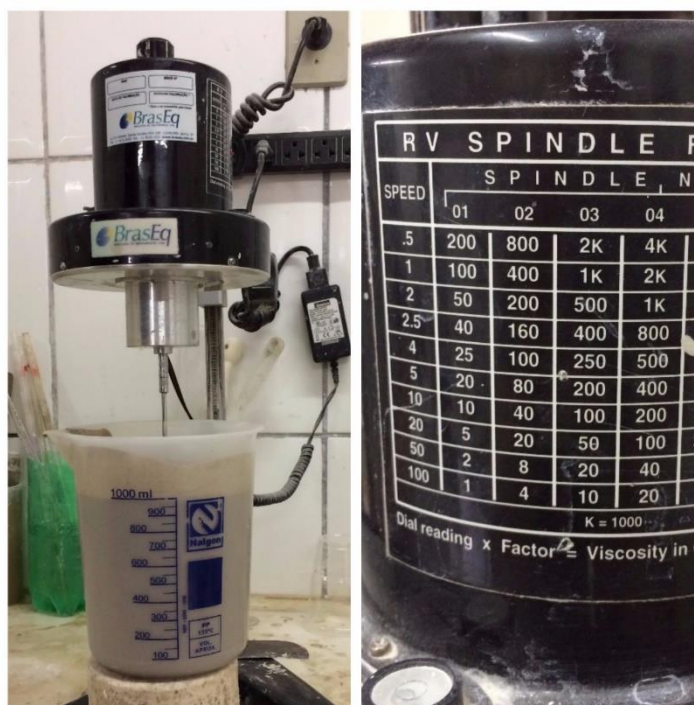
Figura 3.11 – Determinação da reologia através do uso de viscosímetro Brookfield e um béquer com barbotina.
