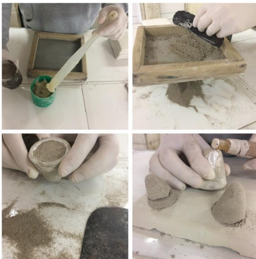
Figura 3.7 – Processo de produção dos corpos de prova para o teste de fundência.
