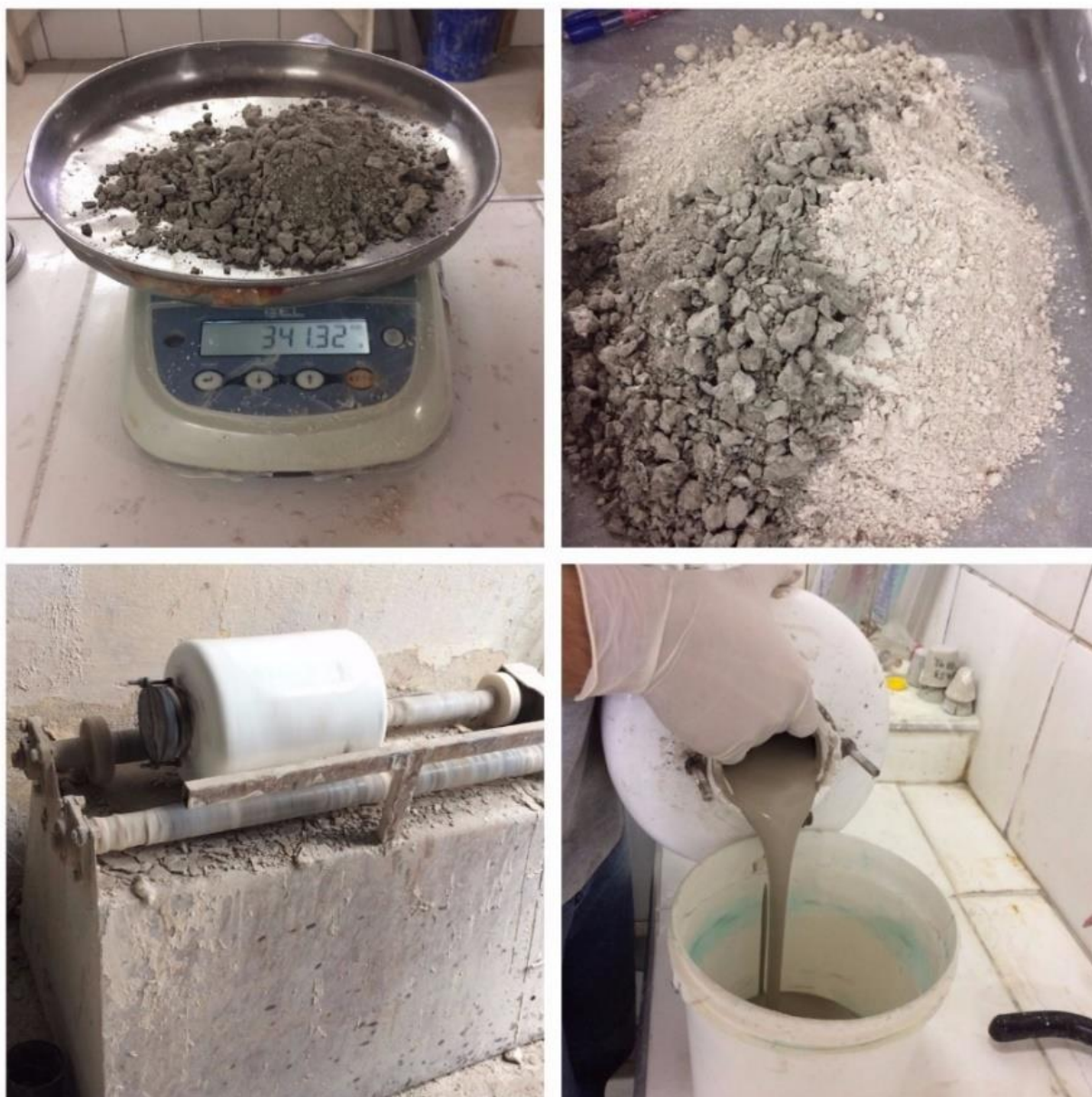
Figura 3.8 – Produção da barbotina de substituição, pesagem, mistura das matérias primas, moagem e barbotina pronta transferida para o balde.
