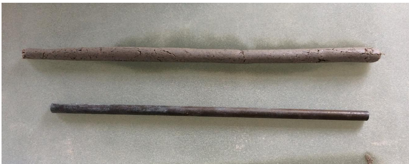
Figura 4.4 – Cilindro feito no ensaio de limite de plasticidade comparado com o gabarito.
