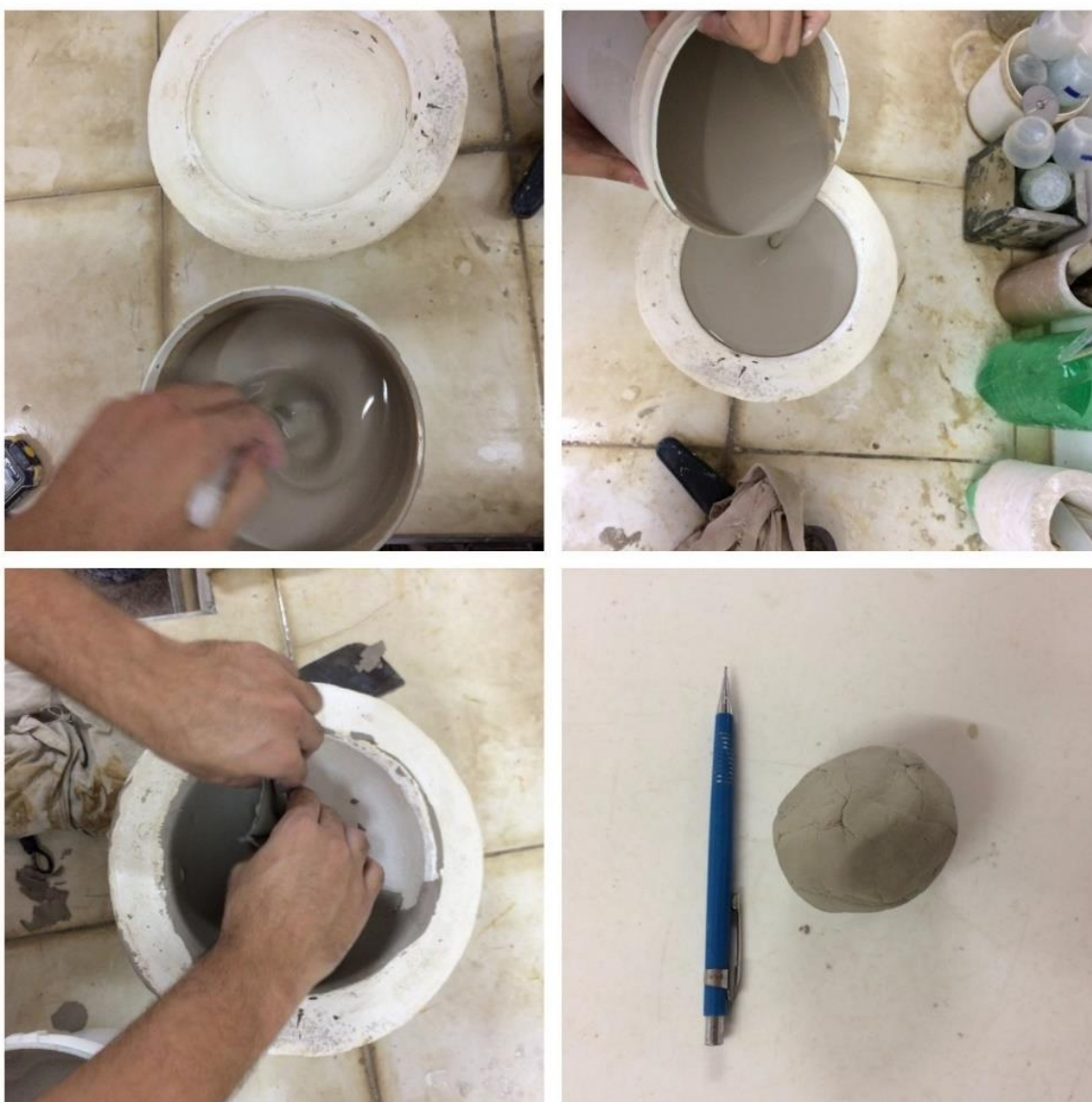
Figura 3.12 – Procedimento para a determinação da velocidade de deposição e tempo de secagem.
