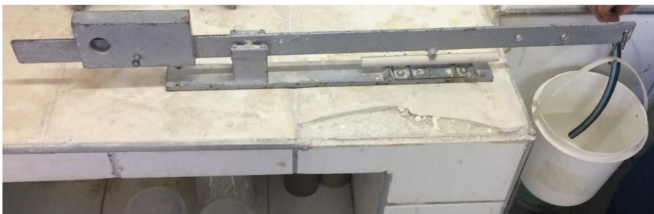
Figura 3.14 – Ensaio de determinação do módulo de ruptura.
