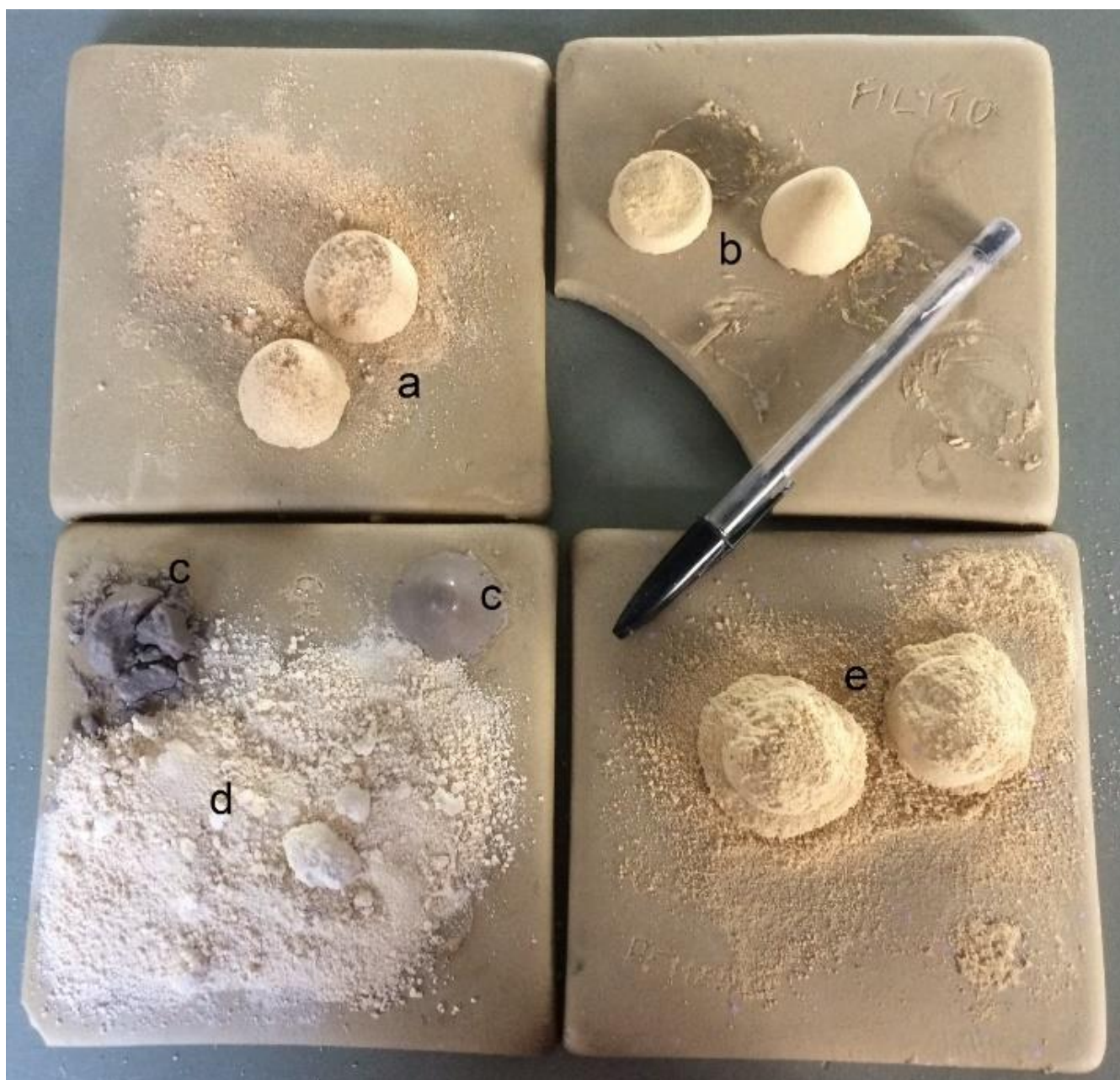
Figura 4.5 – Cones de queima: a – argila Padre Libério; b – Filito; c – granito; d – argila São Simão; e – Resíduo.
