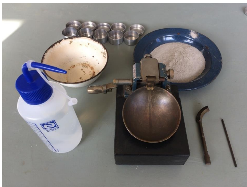
Figura 3.5 – Aparelho de Casagrande (com sua concha), e as ferramentas e utensílios utilizados na determinação do Limite de Liquidez.
