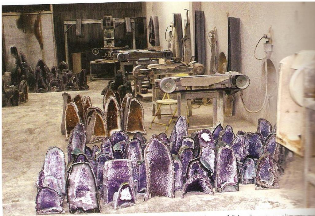
**Figura 5: Oficina de corte e polimento (lapidação) para confecção de capelas a partir de geodos de ametista, da empresa Legep Mineração, em Ametista do Sul, Rio Grande do Sul. Fonte: Cornejo e Bartorelli, 2014.**
