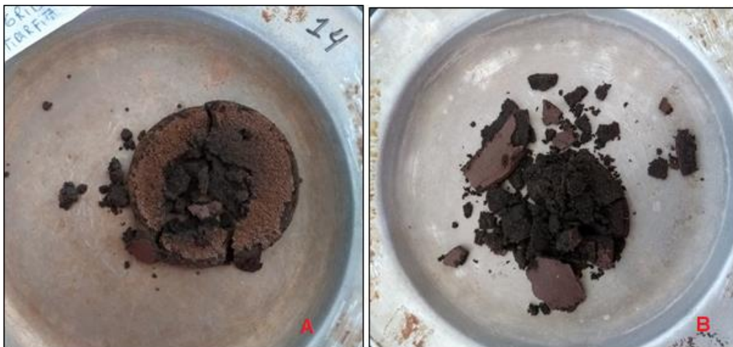
Figura 22 - A) Torta obtida a partir da filtração utilizando pedra pomes verde com 1,3 cm de espessura em 275mm de Hg e B) 400mm de Hg
