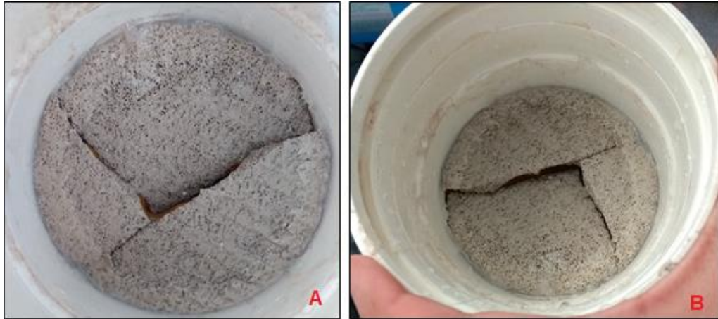
Figura 24 - Concreto celular de 1,3 cm de espessura utilizando vácuo de 200mm de Hg
