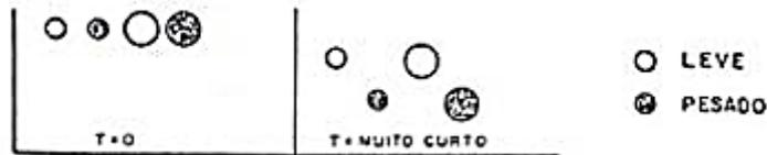
**Figura 2.5-**Mecanismo Aceleração diferencial
