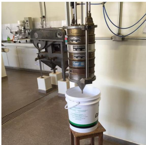
**Figura 3.10-** Peneirador suspenso, utilizado para peneiramento a úmido
