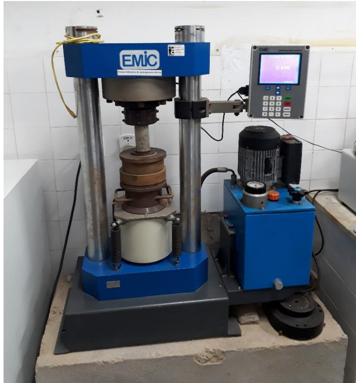
Figura 27 – Teste de compressão em prensa Emic hidráulica de acionamento elétrico.
