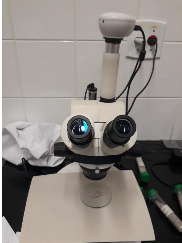
Figura 19 – Lupa binocular Laborana usada para determinar a forma dos grãos.
