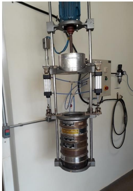
Figura 17 – Agitador de peneiras suspenso usado nos peneiramentos.
