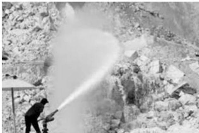
Figura 4 – Lavra de areia em cava seca com desmonte hidráulico. Fonte: Almeida & Luz 2012.
