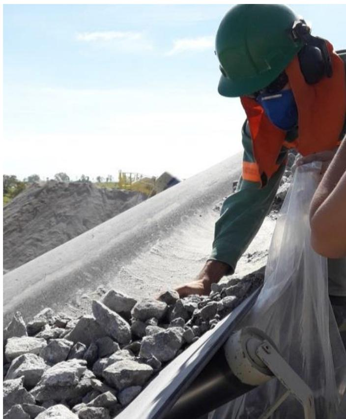
Figura 3.1: Coleta de Amostra durante percurso do Material na Correia
