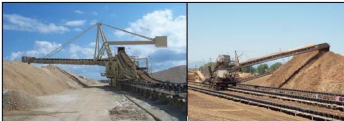
Figura 13: Método de disposição de estéril por correia.
