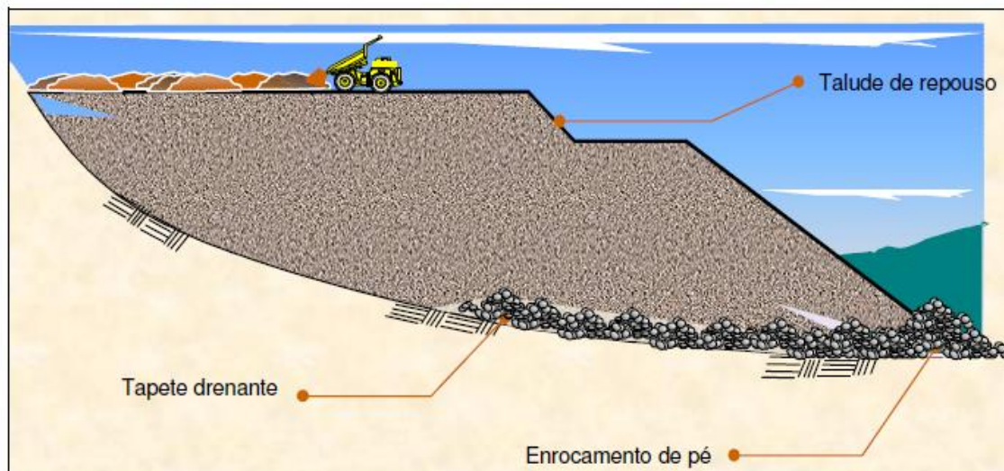
Figura 11: Representação do método ascendente de disposição do estéril.
