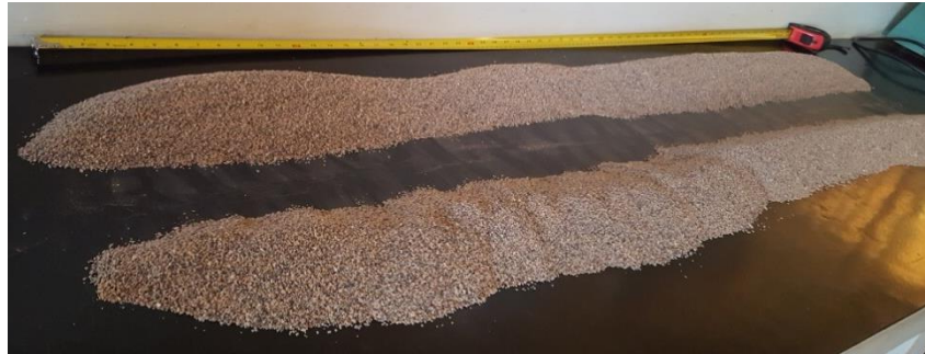
Figura 3.3 – Pilha alongada dividida ao meio (longitudinalmente).
