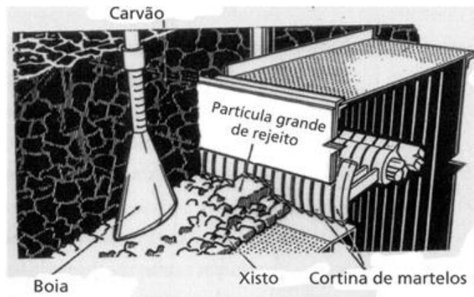
Figura 2.11 – Jigue McNally (Chaves & Chaves-Filho 2013).
