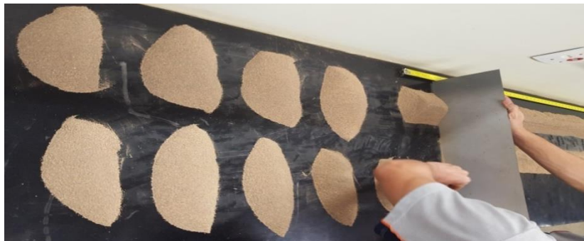
Figura 3.4 – Pilha alongada dividida em espaçamentos equidistantes (transversalmente).
