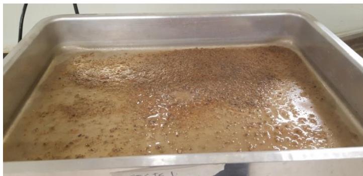
Figura 3.8 – Material leve (rejeito) na bandeja metálica.
