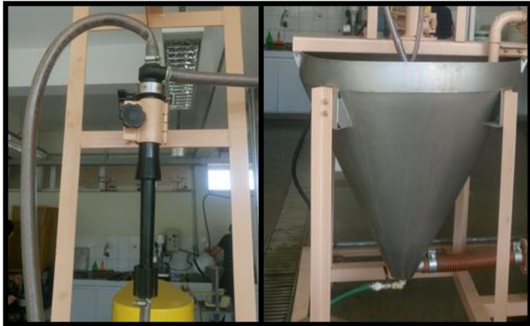
Figura 9: (a) Hidroclicone e (b) reservatório.
