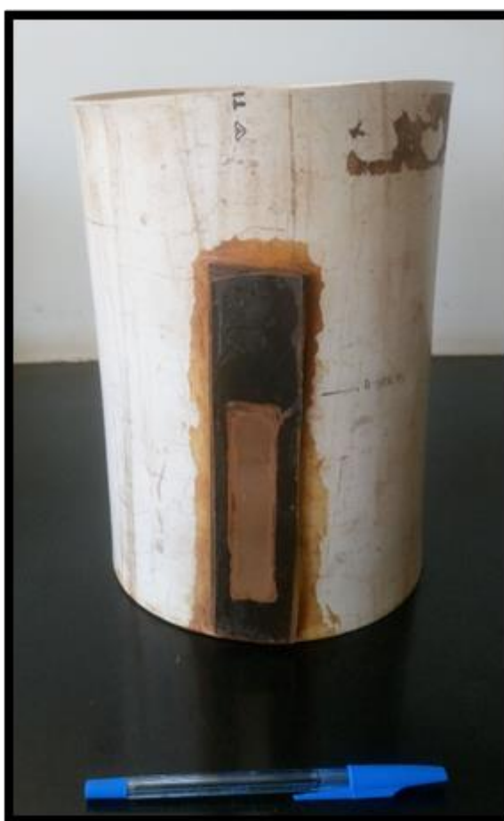
Figura 10: Cuba de deslamagem.
