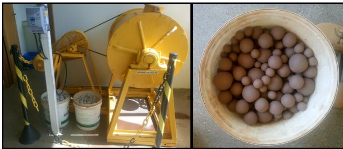
Figura 4: (a) Moinho de bolas, e (b) corpos moedores cerâmicos.
