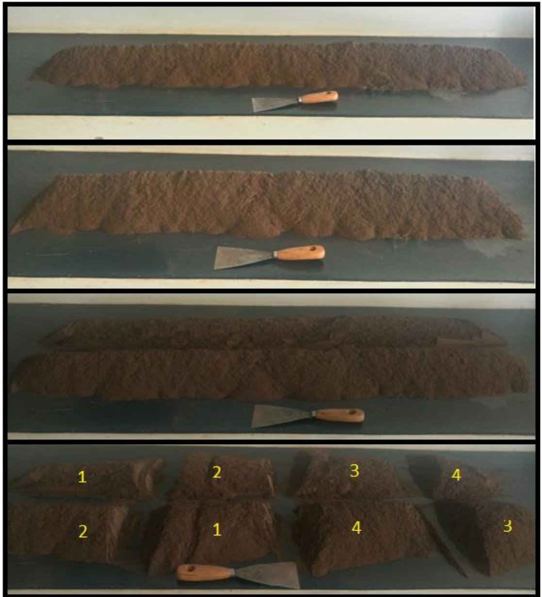
Figura 8: Etapas do quarteamento do material passante em 100#.
