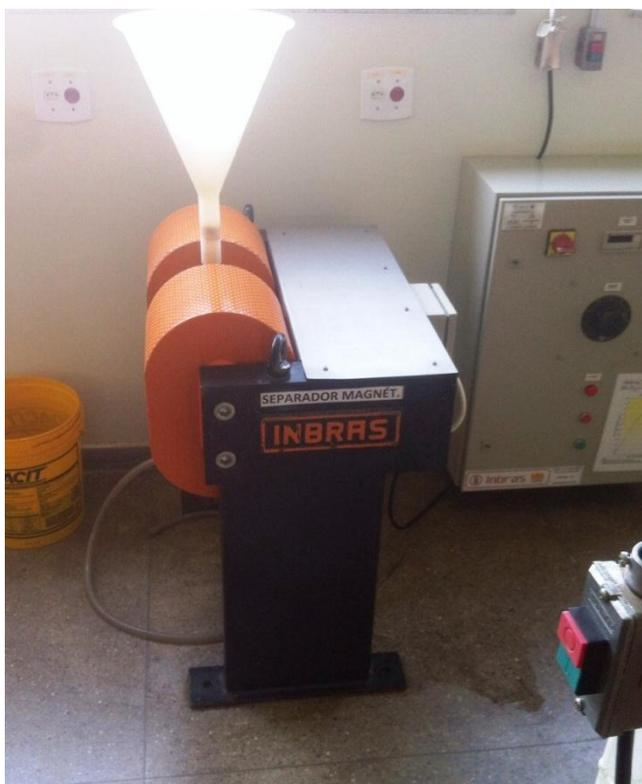
**Figura 4.3** – Separador Magnético Jones utilizado nos ensaios.
