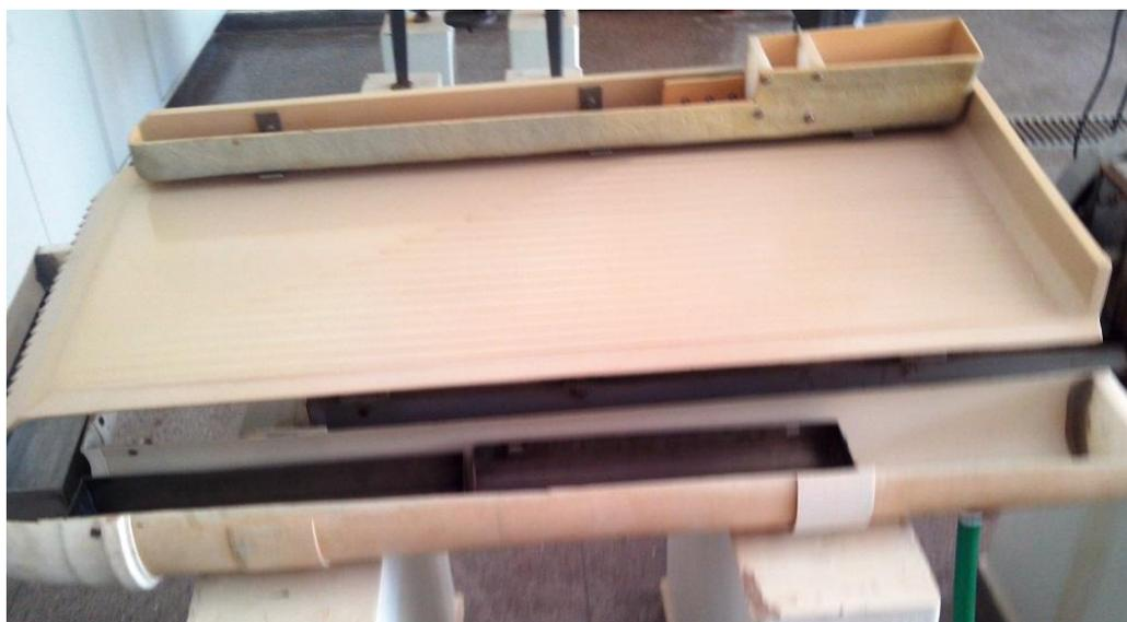
**Figura 4.2** – Mesa Concentradora utilizada nos ensaios.
