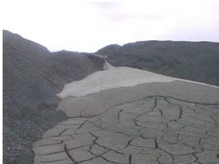
Figura 2.8 - Disposição através de tubulação.
