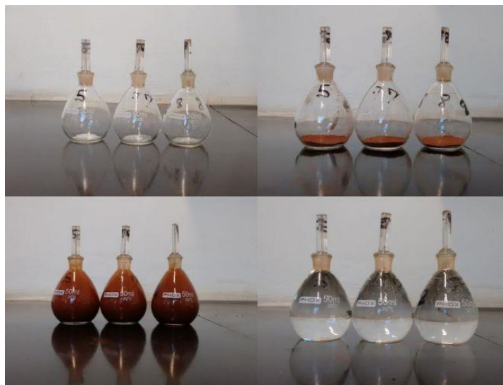
Figura 3.3 - Teste de picnometria. a) picnômetro vazio; b) picnômetro + minério; c) picnômetro + minério + água; d) picnômetro + água.
