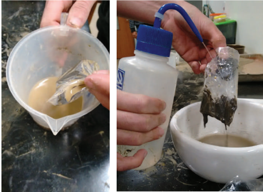
Figura 23 - Desmagnetização a úmido da amostra, usando-se ímã de mão Fonte: Acervo da autora
