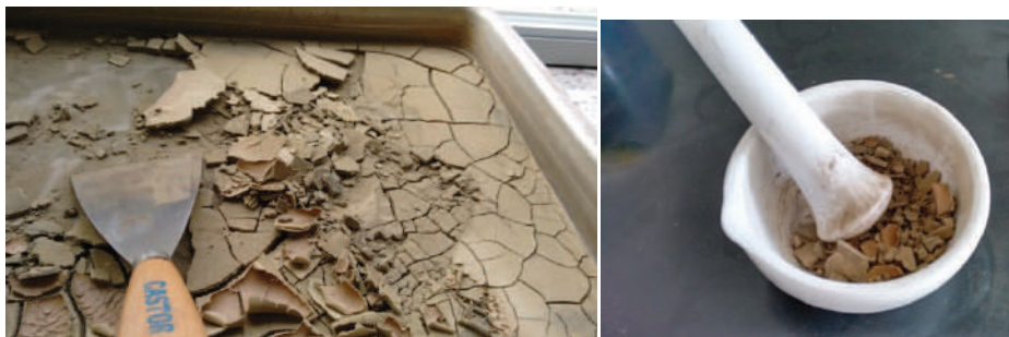
Figura 21 - À esquerda, torrões formados após secagem do material em estufa. À direita, destorroamento das partículas.
