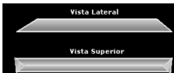
Figura 7 - Representação esquemática da construção de pilha longitudinal. Fonte: OLIVEIRA e AQUINO, 2007
