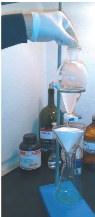
Figura 27 - Arranjo utilizado na separação em líquido denso
