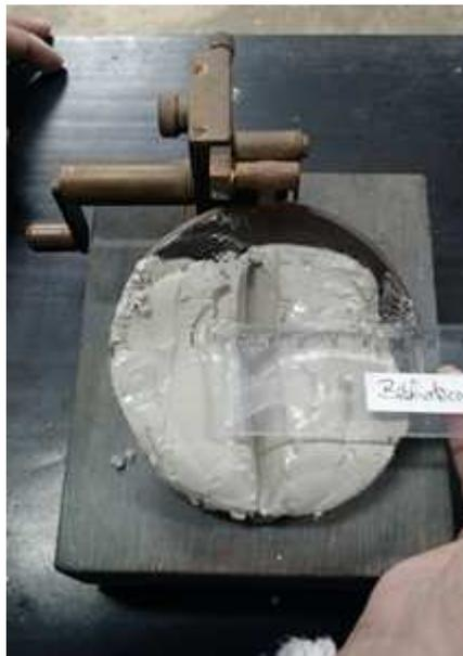
Figura 3.6 - Ensaio de Limite de Liquidez (Casagrande).
