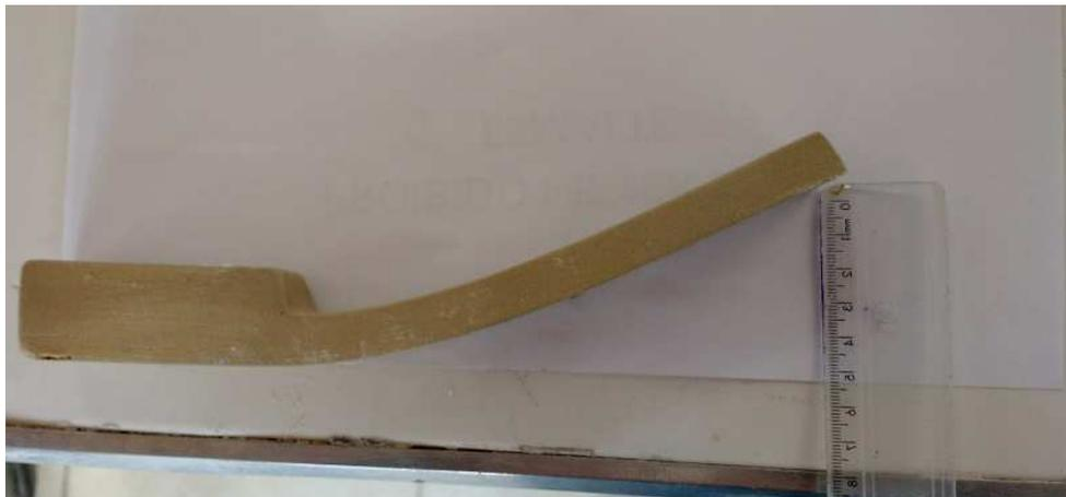
Figura 4.11 - Corpo de prova após a queima sendo medido o ângulo de deformação.
