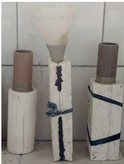
Figura 4.7 - Moldes de gesso para a confecção dos corpos de prova.
