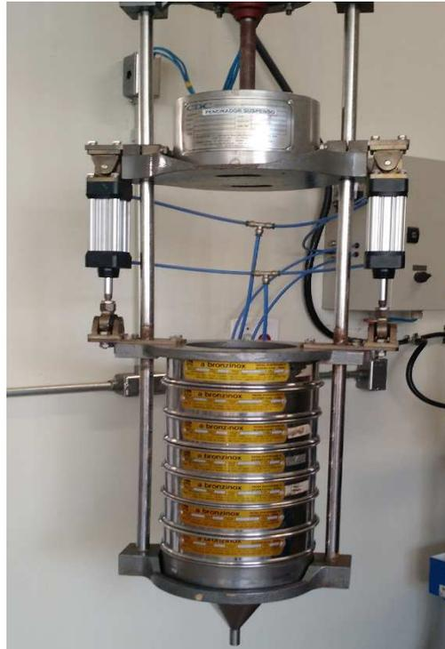
Figura 3.3 - Peneira vibratória suspensa.
