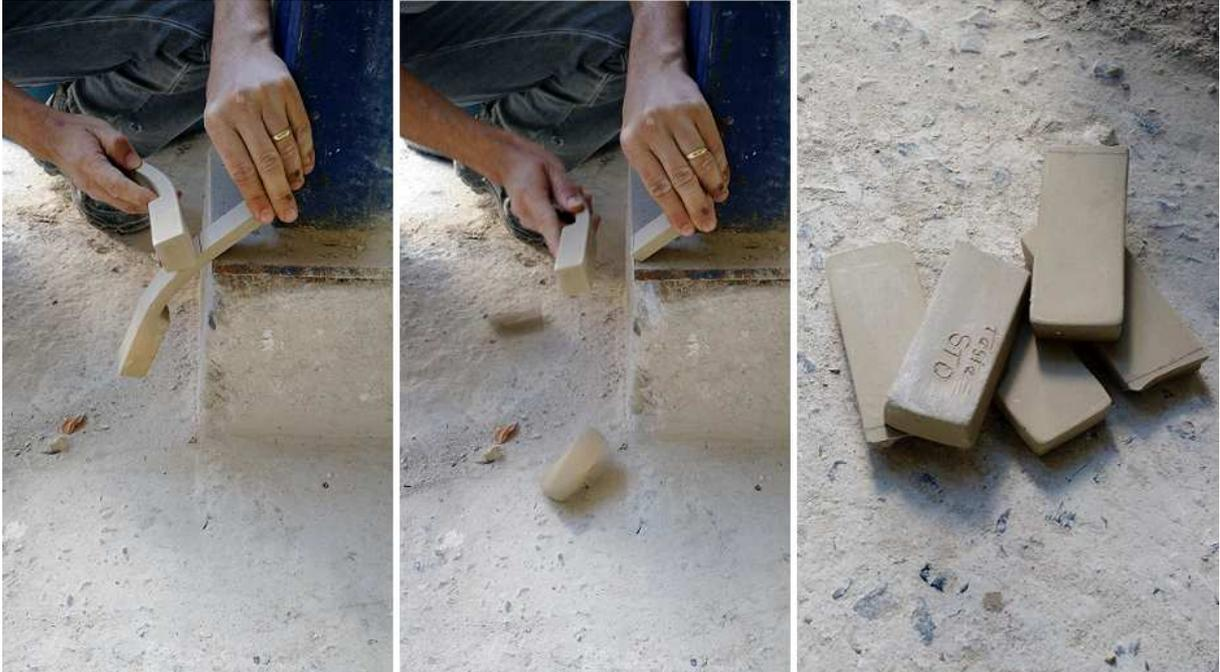
Figura 4.12 - Obtenção dos corpos de prova para a determinação de absorção de água.
