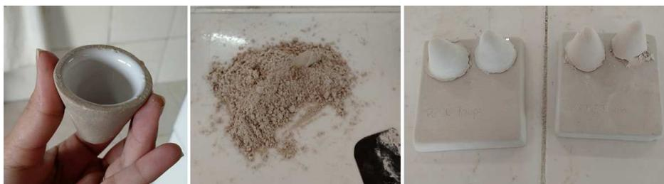
Figura 4.14 - Fabricação dos corpos de prova para a determinação da fundência do material.
