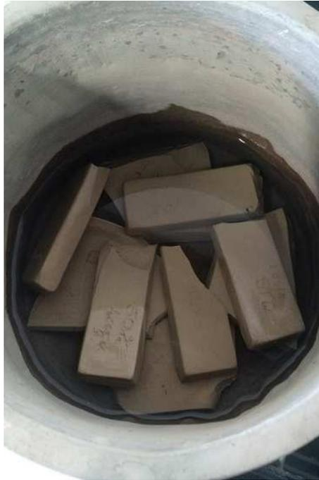
Figura 4.13 - Corpos de prova em cozedura.
