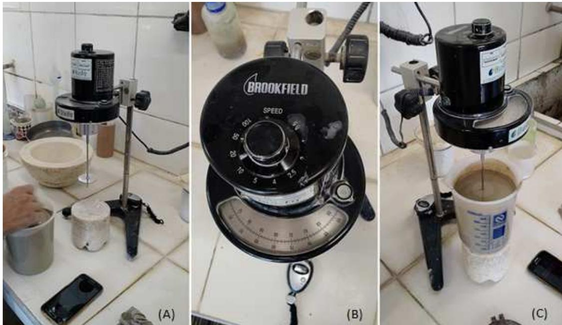
Figura 4.5 - (A) A amostra sendo agitada por minuto, afim de evitar a sedimentação parcial dos sólidos; (B) Onde é realizada a leitura no viscosímetro de Brookfield; (C) Becker posicionado com amostra sob o viscosímetro.
