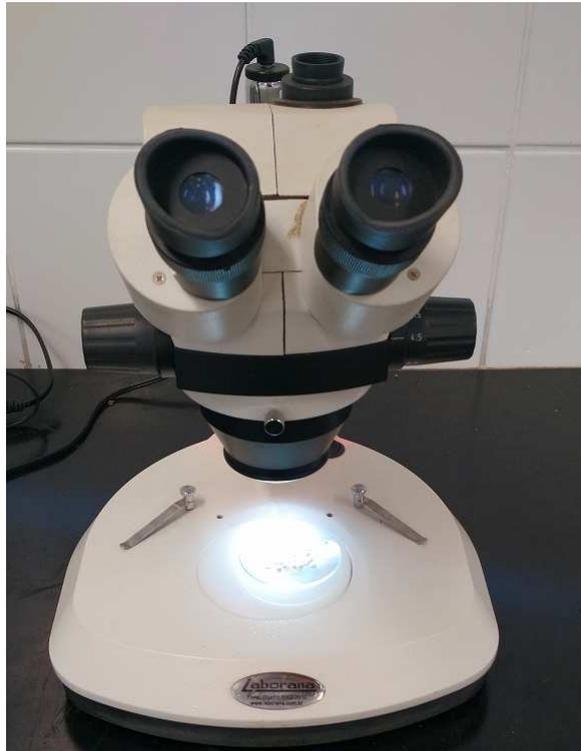
Figura 3.2 - Lupa Binocular.
