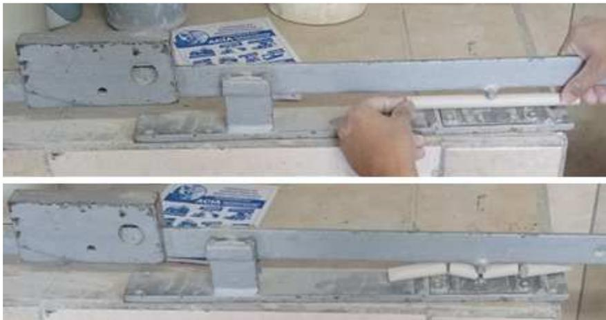
Figura 4.9 - Ensaio de Determinação do Módulo de Ruptura.
