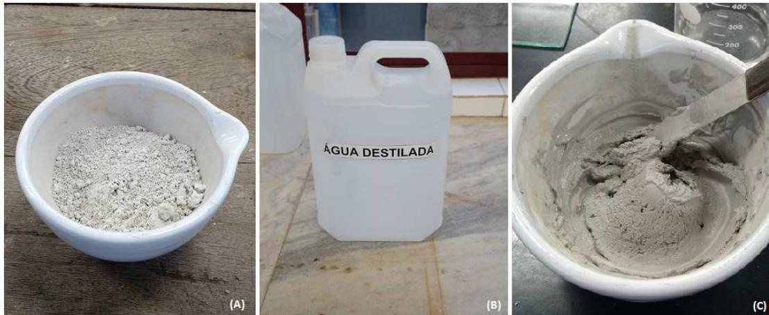
Figura 3.4 - (A) 200 gramas de material para o ensaio; (B) Água destilada utilizada no ensaio; (C) Mistura com consistência plástica.
