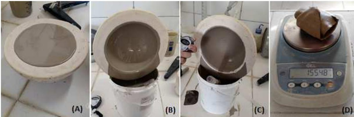
Figura 4.6 - (A) Massa vertida no molde de gesso; (B) Drenagem do excesso de barbotina; (C) Calota já sem brilho; (D) Massa destacada sendo pesada.
