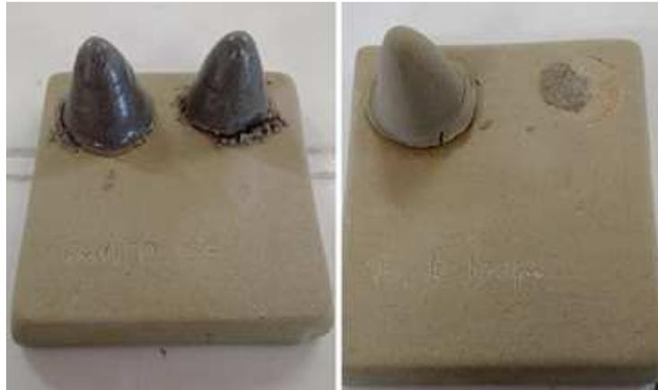
Figura 5.7 - Teste de fundência da amostra.
