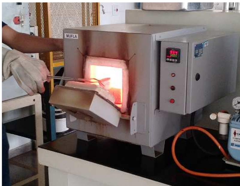
Figura 3.7 - Calcinação da amostra em forno mufla.
