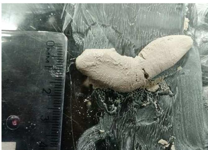
Figura 5.3 - Cilindro para o ensaio do limite de plasticidade.
