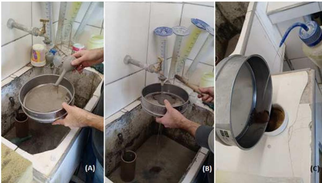
Figura 4.2 - (A) 100 ml utilizados para o peso específico para determinar a % de resíduos; (B) material passando pela peneira de 325# (0,044 mm) com a ajuda de água corrente e uma baqueta de madeira. (C) material retido na peneira sendo transferido para uma cápsula com auxílio de uma piceta.
