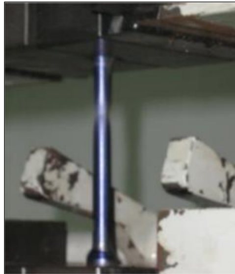
Figura 19 - Corpo de prova ensaiado com o surgimento do fenômeno de estricção.
