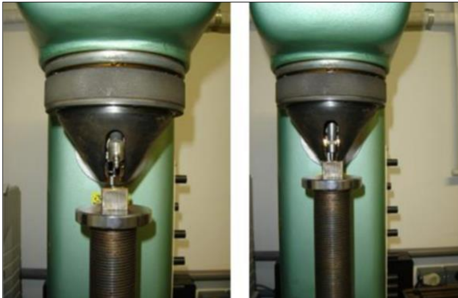
Figura 25 - Medição de dureza Vickers em durômetro do tipo LPM
