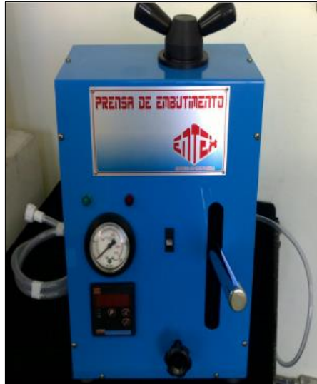
Figura 32 - Prensa de embutimento metalográfico Fonte: Enila equipamentos (2017)
