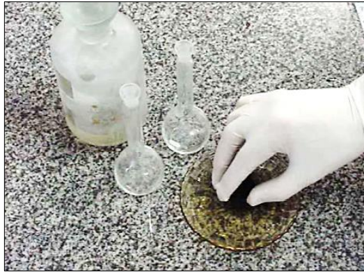
Figura 35 - Imersão do metal no líquido ácido Fonte: Borges (2006)
