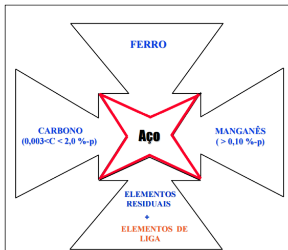
Figura 26 - Esquema representando a constituição dos aços.
